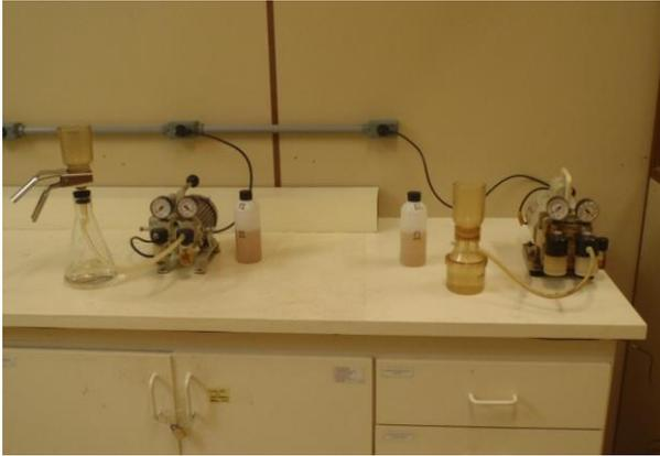
Figura 9 – Bancada para análise de sedimentos em suspensão pelo método de filtração a vácuo.
