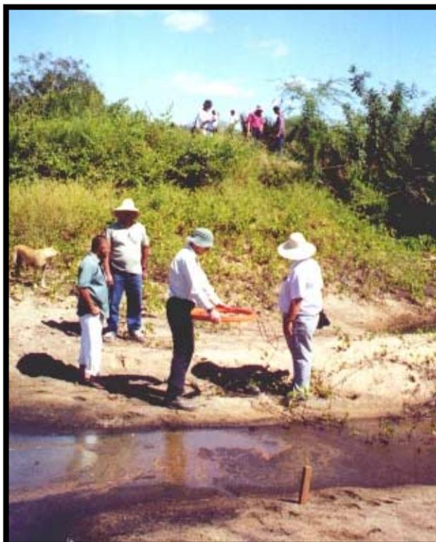
**Foto 12** – O geofísico Richard e o geólogo Enjôlras efetuam medidas do dipolo vertical no transmissor do EM34 no perfil 02
