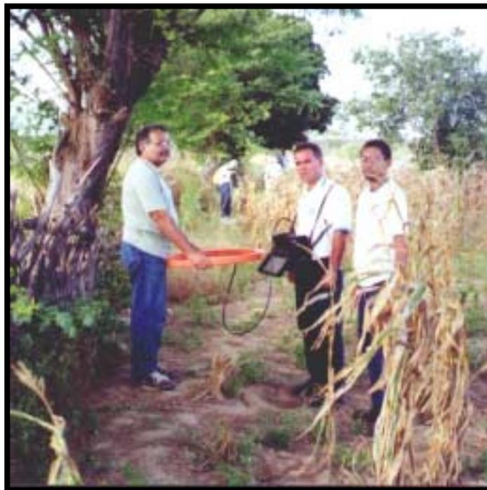
**Foto 10** – O técnico de geologia Almir e os geofísicos Roberto e João José efetuam medidas do dipolo vertical no receptor do EM34 na sondagem vertical 01
