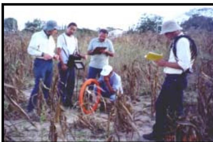
**Foto 11** – Os geofísicos Richard, João José e Gilein, acompanhados do hidrogeólogo Manoel Júlio (agachado) e o técnico de geologia Almir, efetuam medidas do dipolo horizontal no receptor do EM34 na sondagem vertical 02
