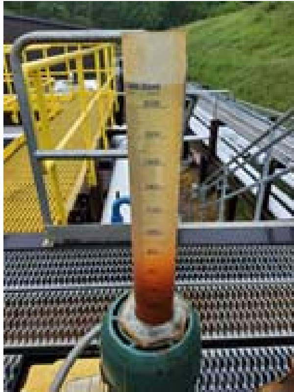
Figura 6B. Detalhe da reação de precipitação de metais pelo método da oxidação.
