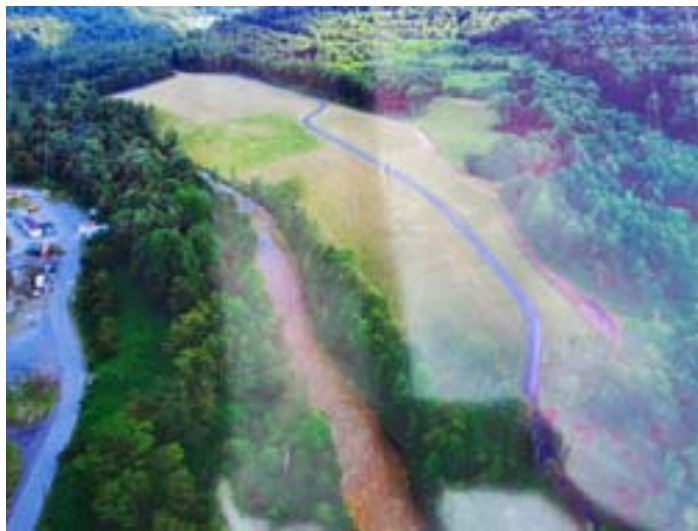
Figura 12B. Área recuperada pela metodologia de incorporar materiais alcalinos e fertilizantes diretamente no solo contaminado por rejeito de carvão.
