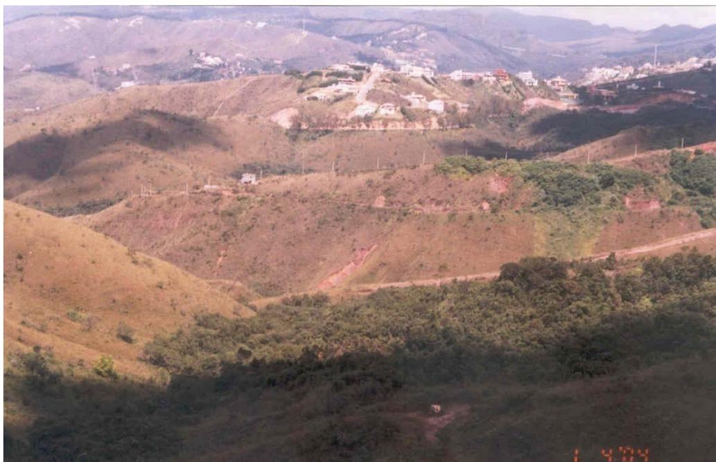
FOTO 8 – Vista geral do condomínio com diversas feições erosivas, cortes e aterros.
