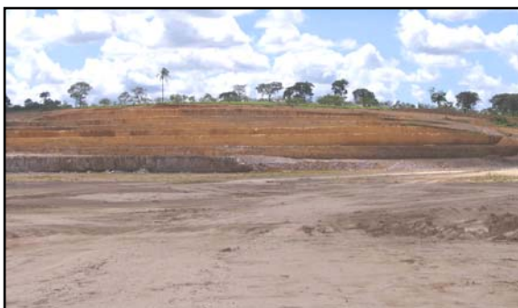
Figura 38: Frente de lavra de argila da Lafarge do Brasil, Arcos. A rocha explorada é um argilito siliciclastico alterado que ocorre sobre embasamento granitóide.
