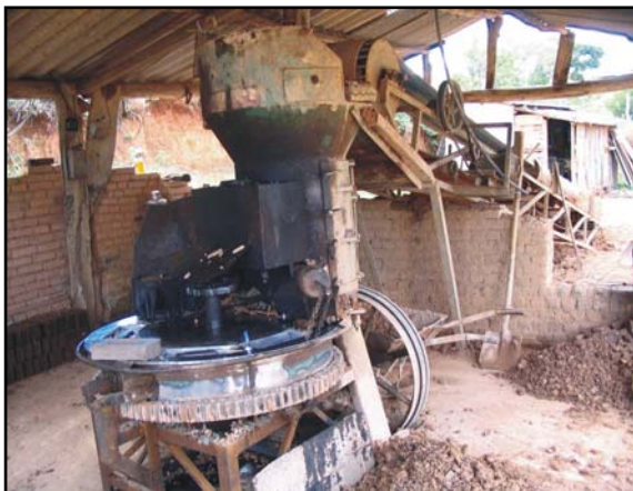
Figura 42: Prensa manual para confecção de tijolos, Barro Preto, Piumhi.
