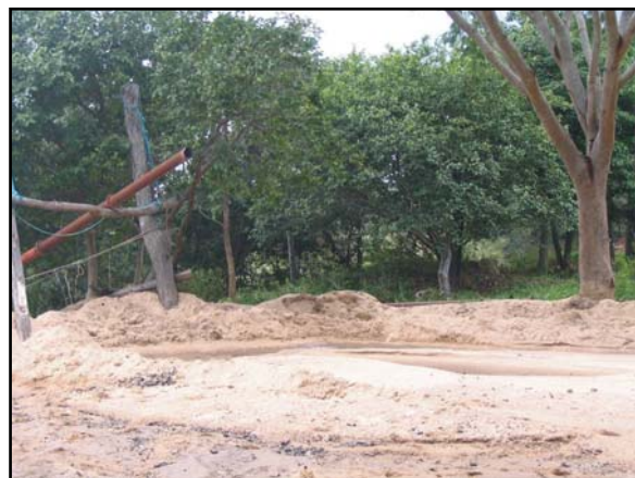
Figura 37: Depósito de areia dragada do Rio Santana no Município de Japaraíba. A areia é comercializada sem processo de separação granulométrica.
