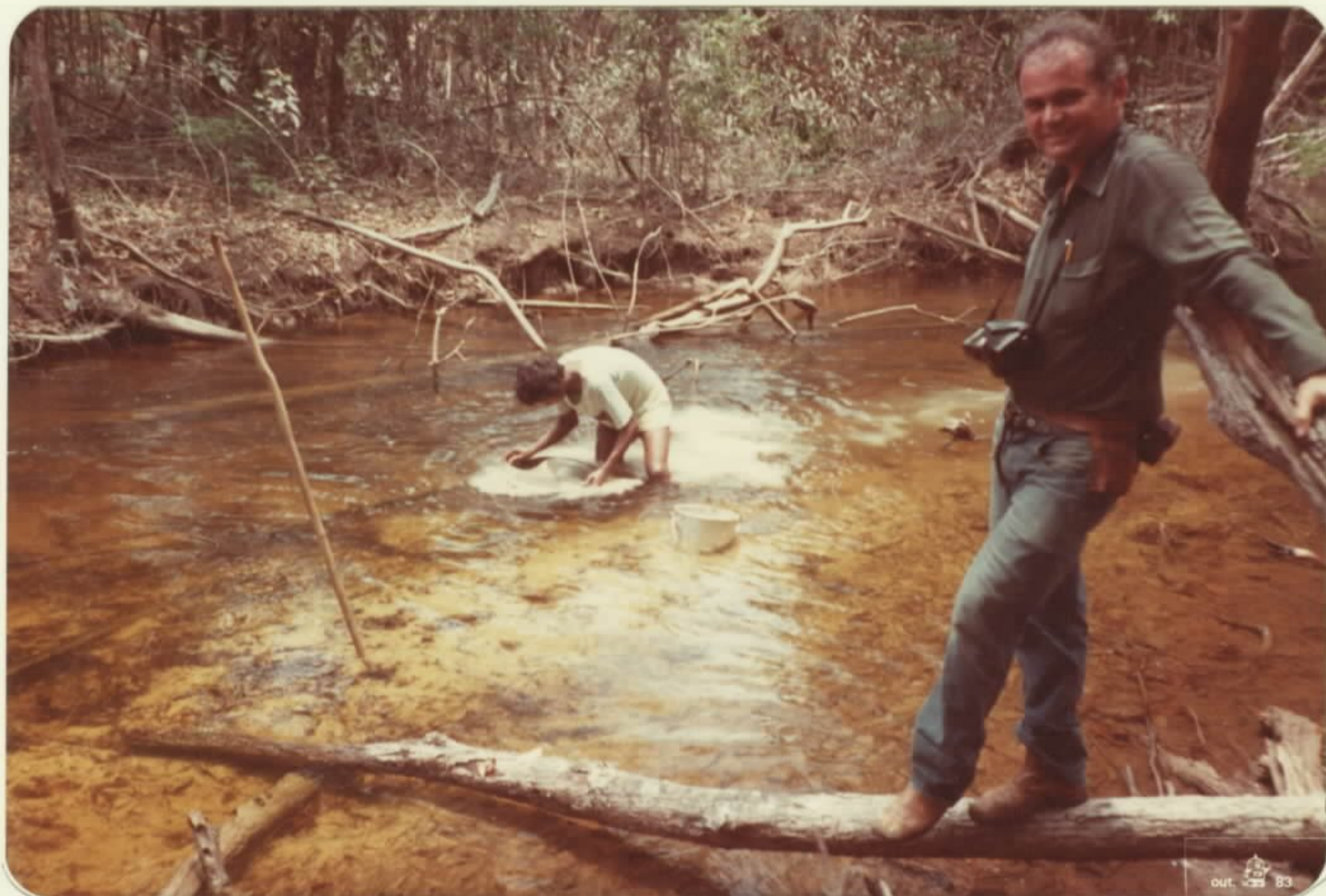
Foto 2 - Amostragem de concentrado de batéia no leito do igarapé Açãeira. Ponto de amostragem RK-05
