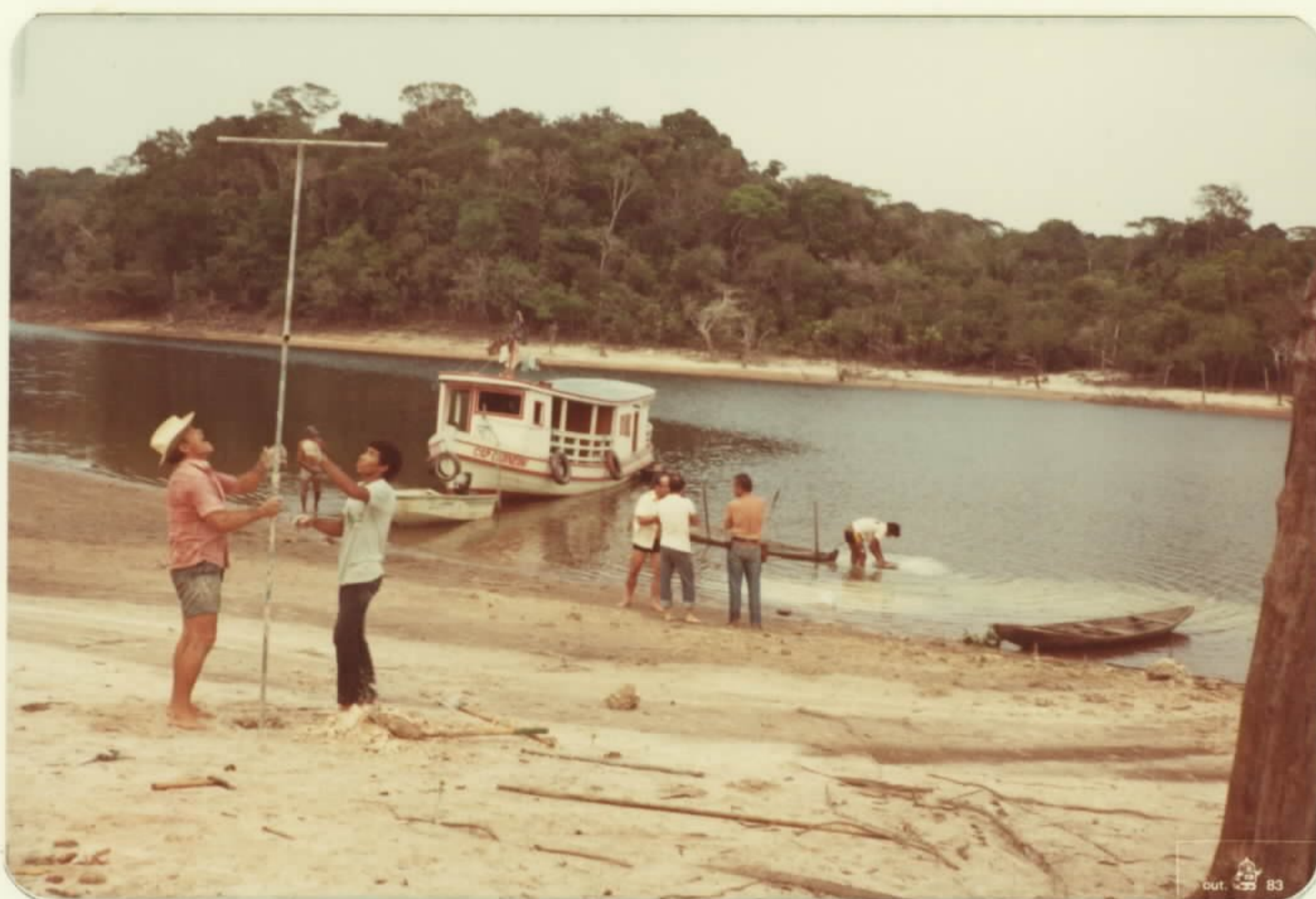
Foto 3 - Sondagem a trado manual. Margem direita do igarapé Paricazinho. Ponto de amostragem RK-08
