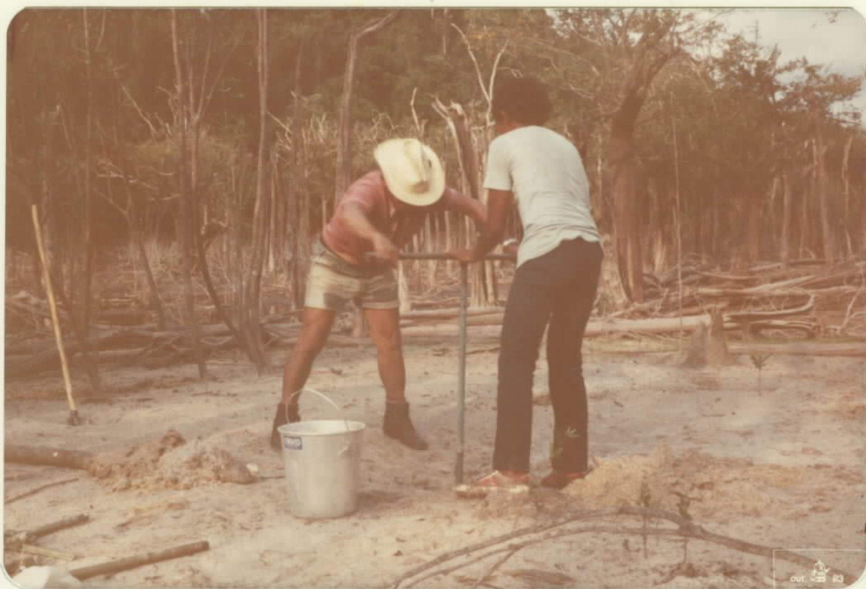
Foto 1 - Detalhe de sondagem a trado manual . Margem esquerda do igarapé Jacundazinho. Ponto de amostragem RK-25
