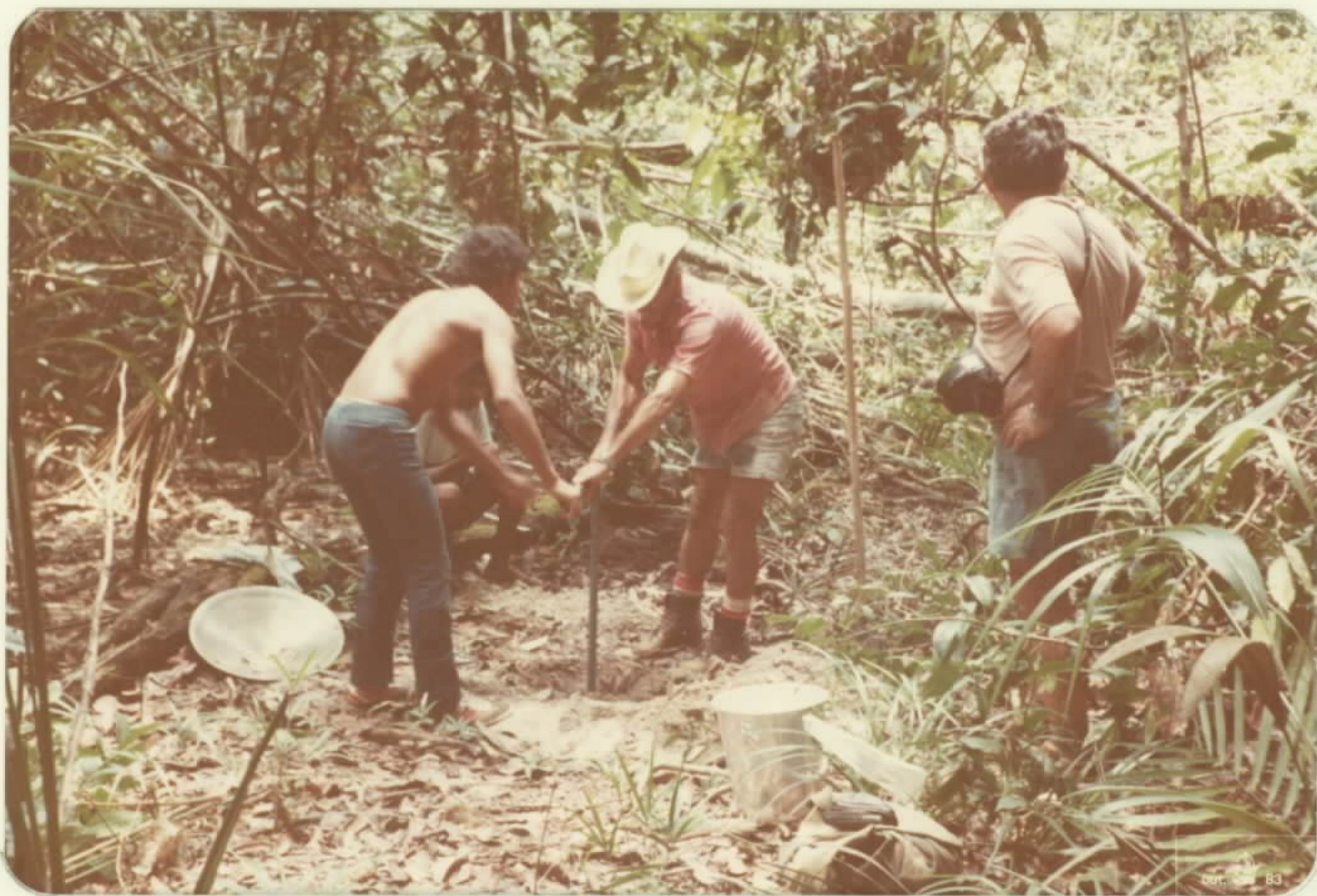
Foto 4 - Sondagem a trado manual. Ponto de amostragem RK-04
