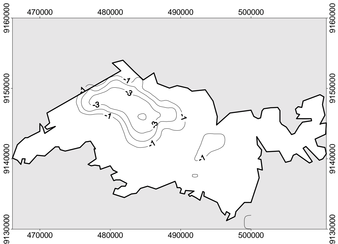
Fig. 4.10- Mapa de anomalia residual calculada ou modelada após cinco iterações. Intervalo de contorno 0,5 mGal. Coordenadas em UTM.
