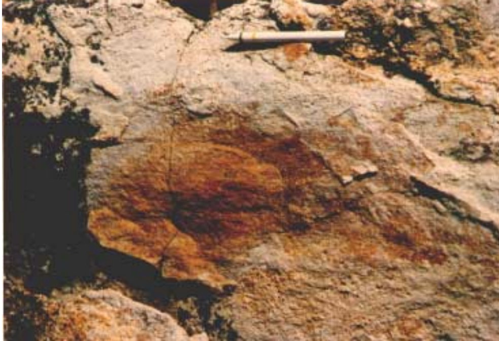
Foto 5.7: Mesofalha de rejeito direcional (49→312) apresentando estria com atitude N005E/36. Falha do Sítio Divisão.
