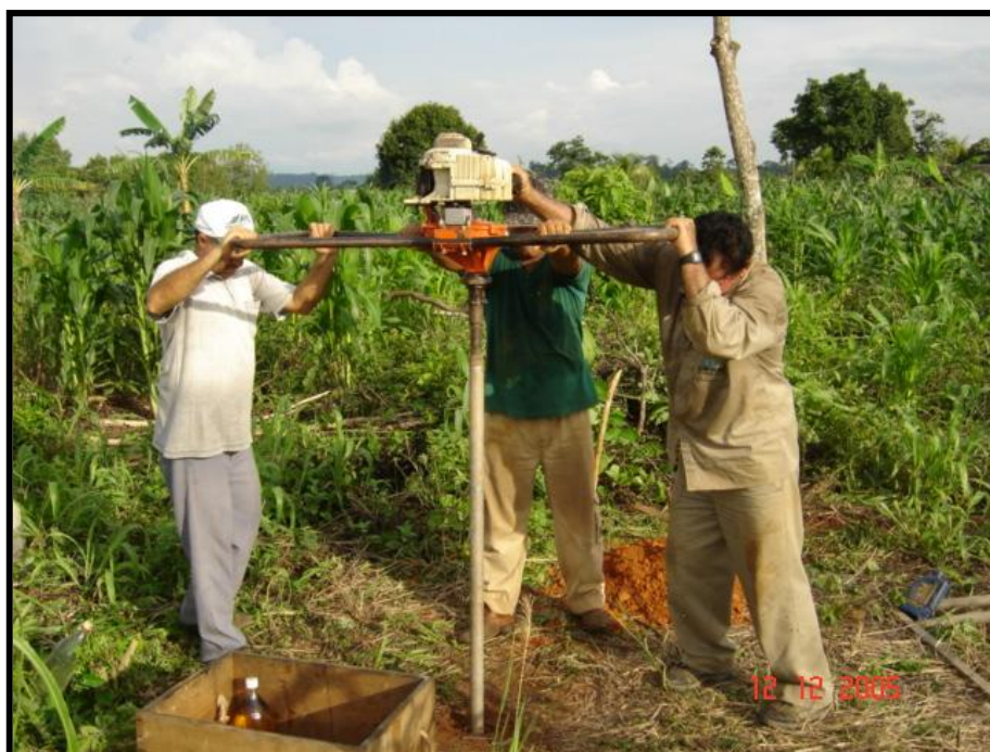
Foto 9. Execução de furo de trado da Área 1.
