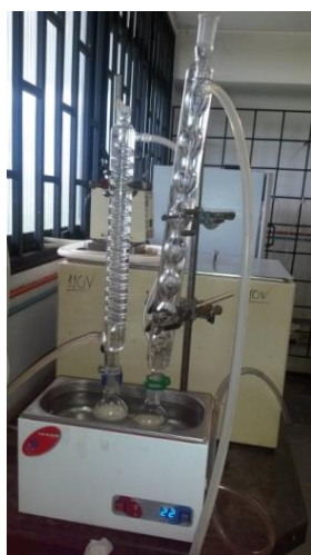
Figura 4.4 - Sistema reacional com banho ultrassônico (US).
