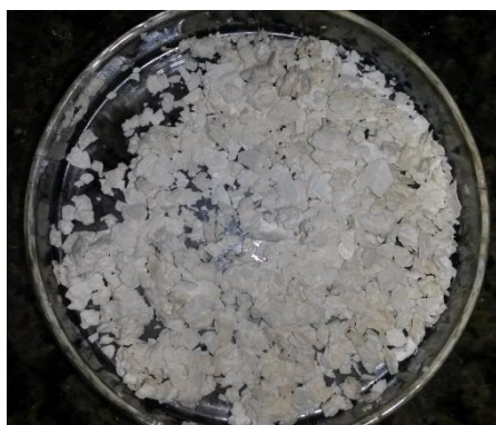
Figura 5.11 - Polissulfona com CaO após a reação em agitação magnética.
