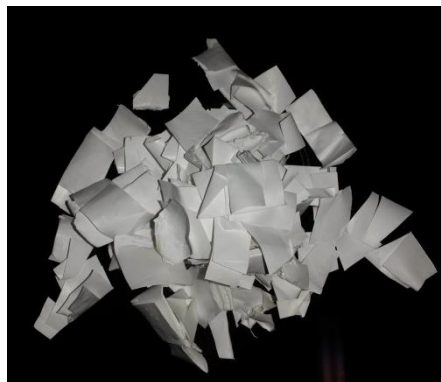
Figura 5.10 - Suporte impregnado com CaO utilizado para transesterificação do óleo de soja.
