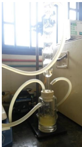
Figura 4.6 - Sistema reacional com recirculação líquida (RL).
