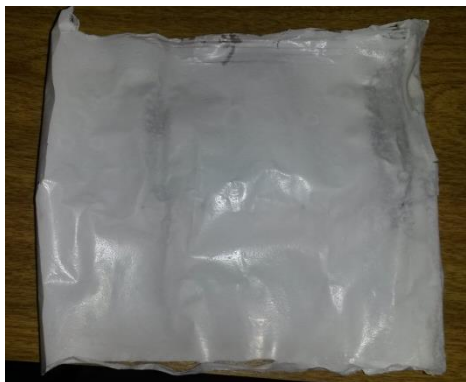
Figura 5.9 - Filme de polissulfona impregnado com CaO.
