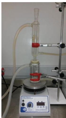
Figura 4.2 - Sistema reacional com agitação magnética (MS).
