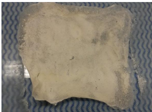
Figura 5.13 - Zirconato de sódio suportado em PVA.
