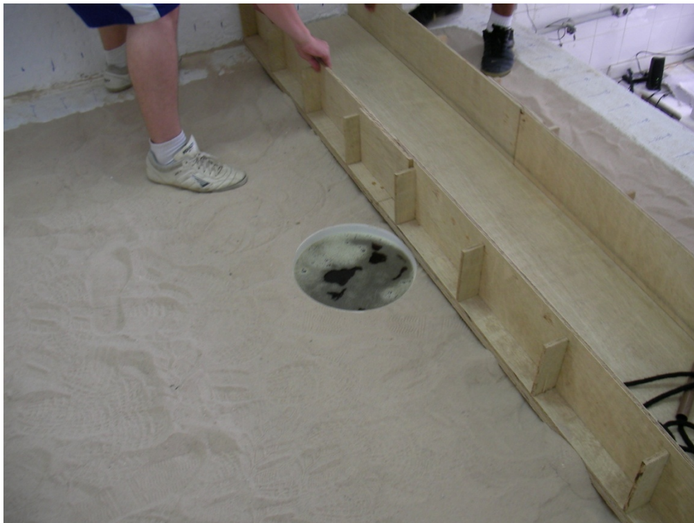
Figura 3.12 Início do monitoramento depois do derramamento de óleo.
