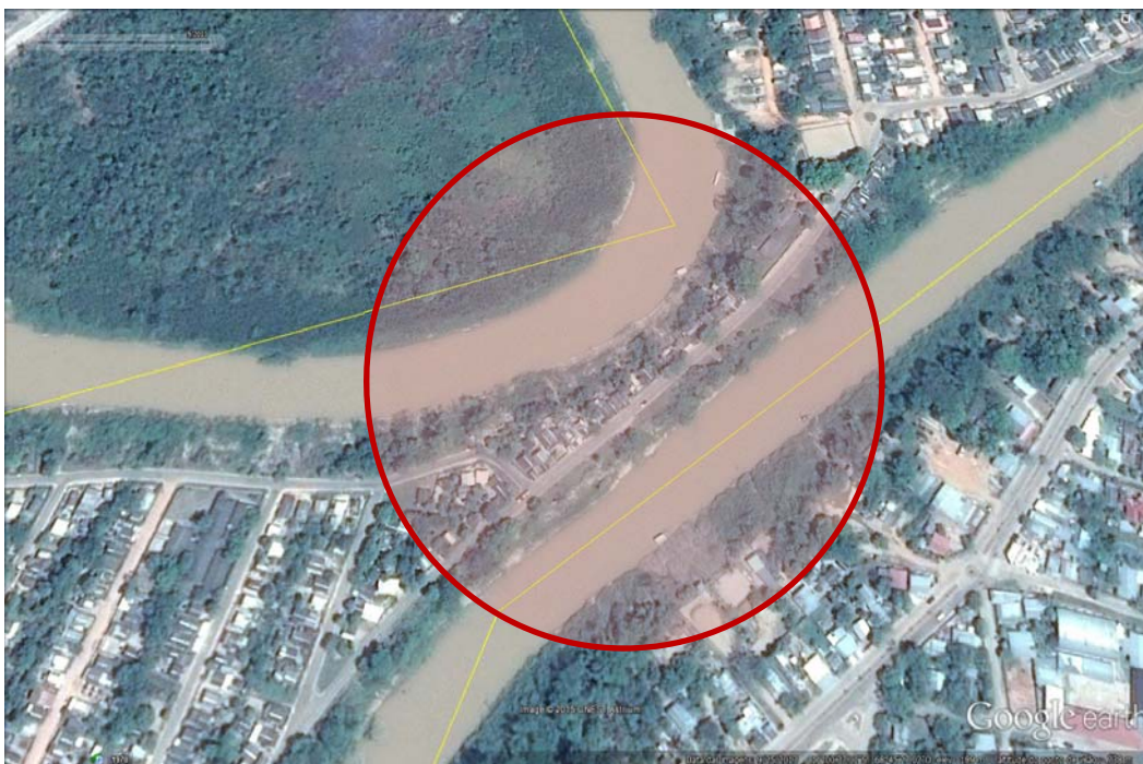
Figura 7: a) Detalhe do setor do rio Acre em processo de avulsão no ano de 2005; b) Detalhe do setor do rio Acre em processo de avulsão no ano de 2013. Medições preliminares tomadas por meio de sucessivas imagens de satélite e levantamento de campo demonstram que, em uma década, o setor estrangulado foi reduzido de 60 para 25 metros.
