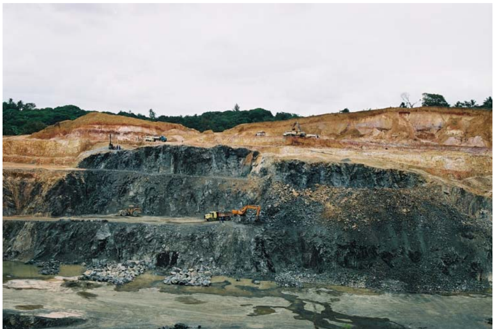
Foto 17 - Morro de rocha granulítica com delgado capeamento de sedimentos cenozóicos, possibilitando a lavra. Pedreira Parafuso, município de SimõesFilho, RMS, Ba.
