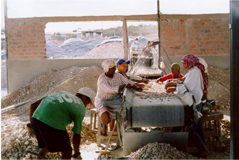
Foto 3 - Beneficiamento com separação manual de quartzo e feldspato. Sede do Município de Castro Alves, Ba.
