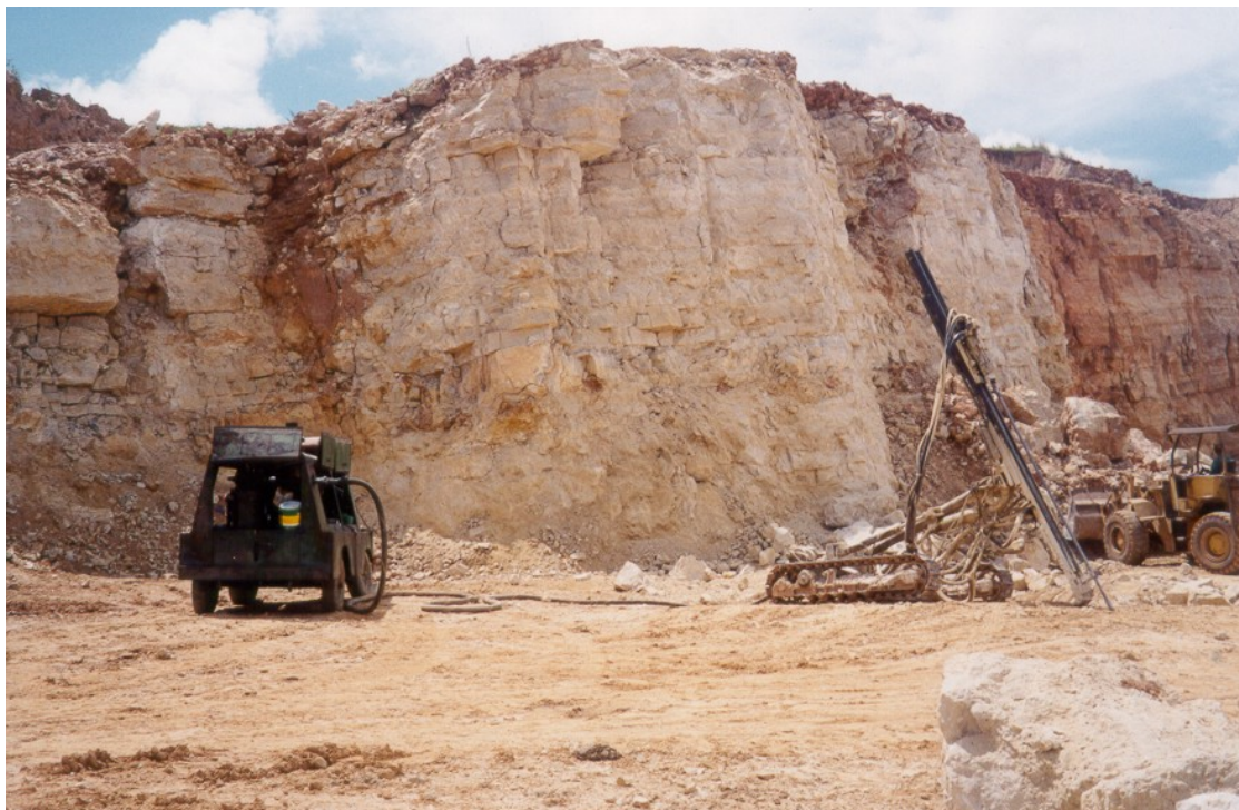
Foto 13 – Frente de lavra de dolomito (corretivo de solo) na mina da fazenda São Joaquim, município de Maruim-SE.
