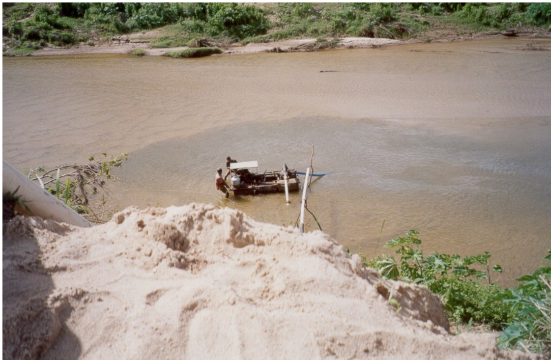
Foto 15 – Areal São Carlos, município de Itaporanga d’Ajuda-SE. Draga em trabalho de extração de areia para construção civil, no leito do rio Vaza-Barris.
