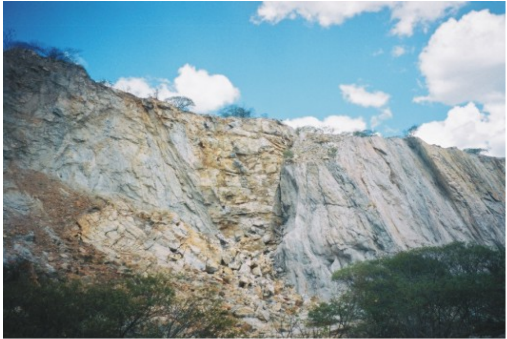
Foto 9 – Frente de lavra em veio de barita boudinado de escala decamétrica. Mina de Santa Luzia, município de Novo Horizonte-Ba.
