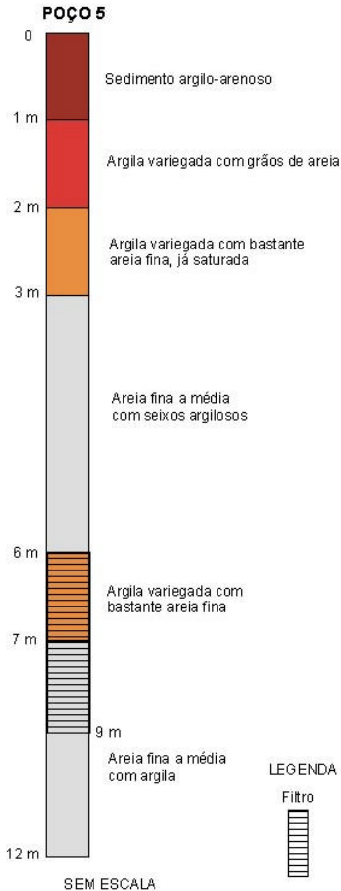
Figura 4 Perfil litológico dos sedimentos obtidos no poço de monitoramento 05 com a posição do filtro.
