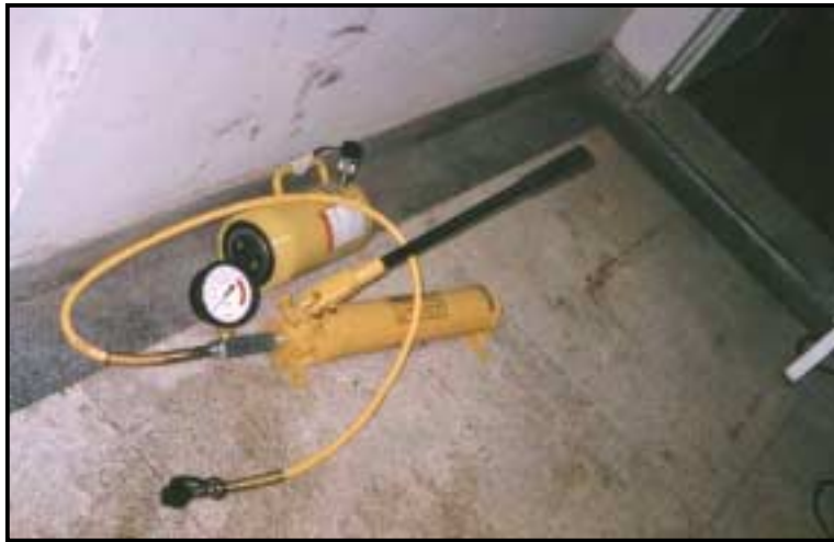
Foto 13 - Cilindro hidráulico com cap. 75 t e bomba manual equipada com manômetro para 10.000 lbs
