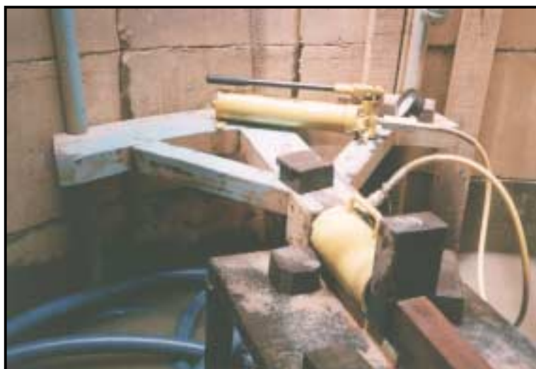
Foto 8 - Sistema de apoio formado por um aço em madeira e hastes verticais
