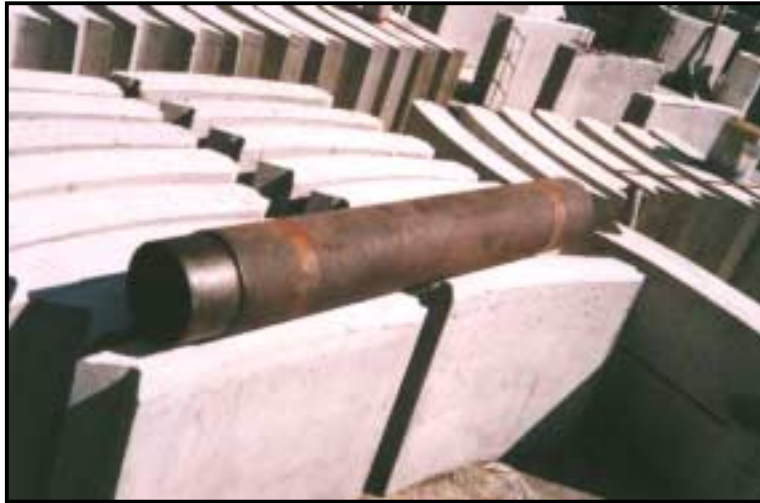
Foto 1 - Conjunto de blocos pré-moldados aguardando tempo de cura para utilização, construídos para teste experimental
