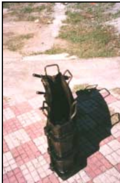
Foto 2 - Fôrma em aço desenvolvida pela UFPE para modelagem de blocos
