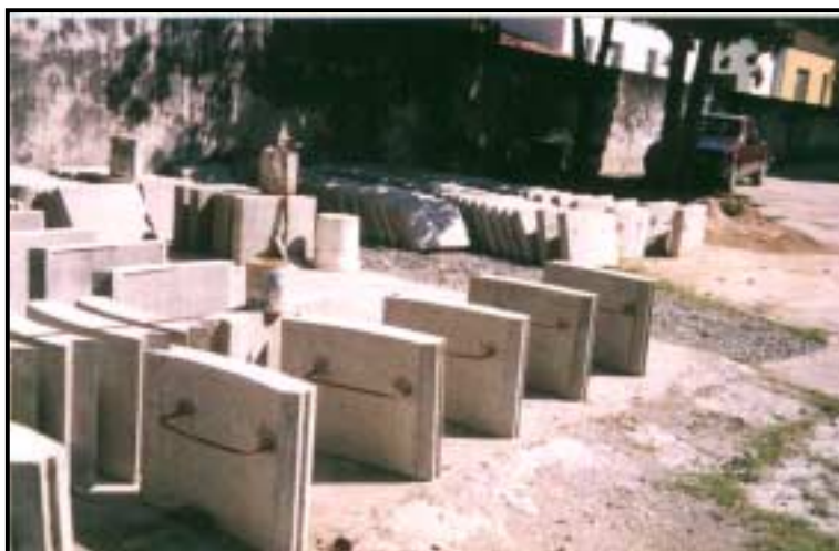
Foto 24 - Blocos especiais com estrutura metálica para suporte de escada
