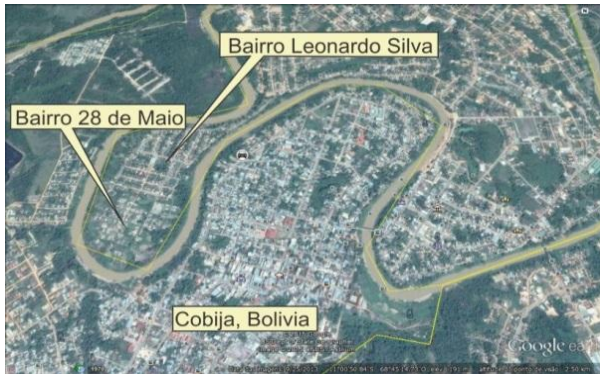
Figura 3: Traçado meândrico do rio Acre em Brasileia, Acre. Observar trecho estrangulado do rio, suscetível a futuro rompimento
