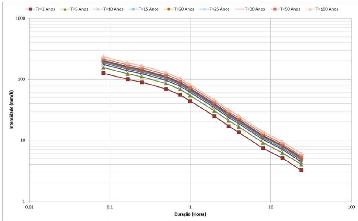
Figura 02 – Curvas intensidade-duração-frequência
