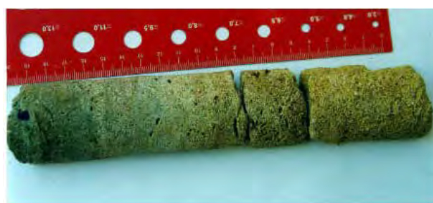
Foto 3.24 - Testemunho do furo 1 PL-01-PE de Paulista, Pernambuco, mostrando a passagem de um arenito mais grosso (direita) para um arenito mais fino (esquerda); esse nível, mais fino, possui cimento carbonático e fragmentos de conchas. (Formação Itamaracá) (Barbosa, 2004).
