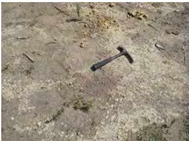
Foto 3.31 – Arenito grosso a médio, de aspecto nodular, nível superior do afloramento na Usina Mulata – Itapissuma, (Ponto LV-201).
