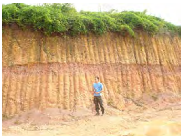
Foto 3.54 – Arenitos do Grupo Barreiras intercalados por níveis conglomeráticos e camadas siltico-argilosas, (Ponto LV-161).
