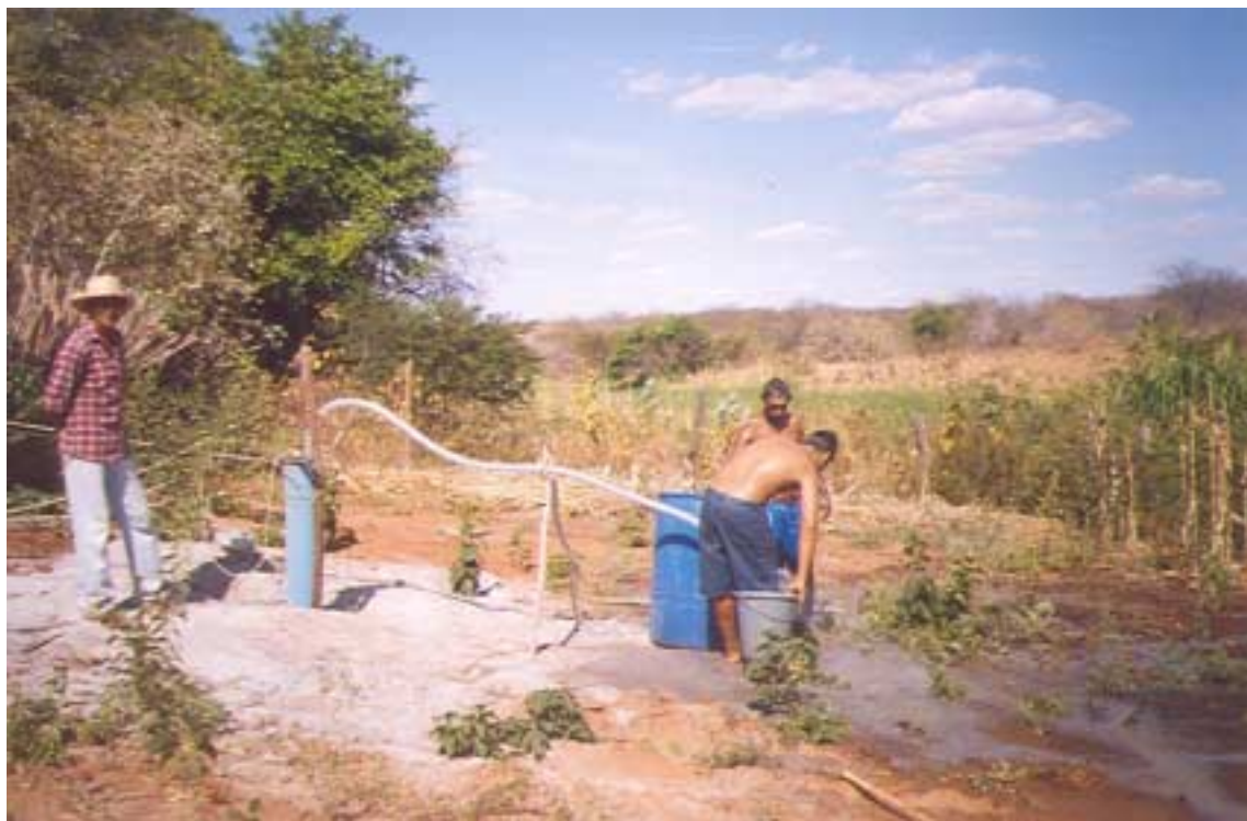
Foto 5.1 - Teste de bombeamento
