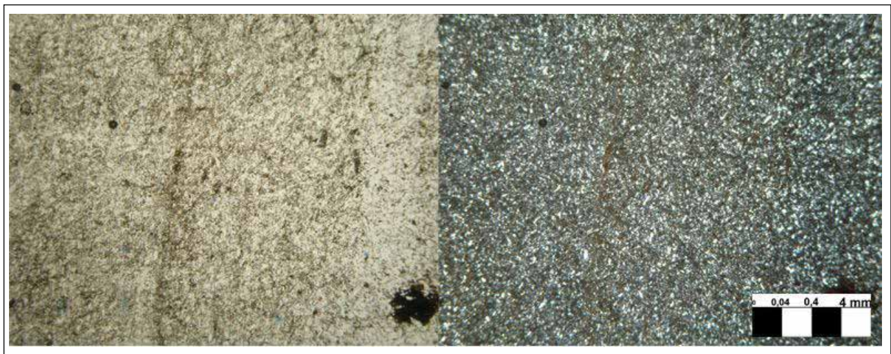
Figura 6.36 - Detalhe do pelito apresentando concentração de quartzo detritico na estrutura da rocha e concentrações de hidróxidos dispersas (aumentos 10x)
