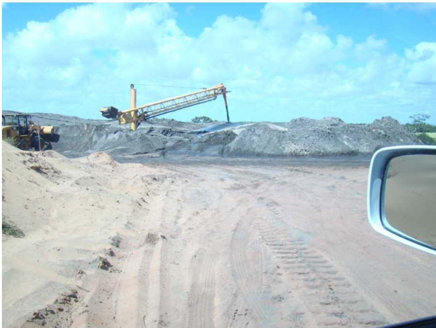
Figura 3.19 – Exploração mecanizada de minerais pesados nos Depósitos eólicos vegetados – Jazida Guaju, Mataraca – PB.
