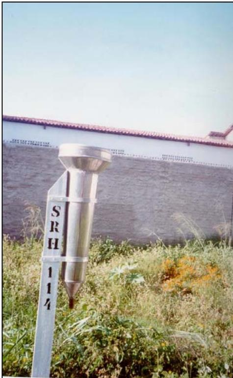
Figura IV. 1 - Estação pluviométrica com pluviômetro convencional, sem cercado, operado pela SECTMA em 2004, no município de Sanharó
