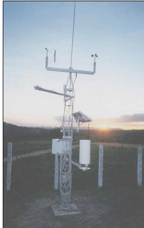
Figura IV. 2 - Estação meteorológica com pluviômetro telemétrico (PCD), operado pela SECTMA em 2004, no município de Caruaru
