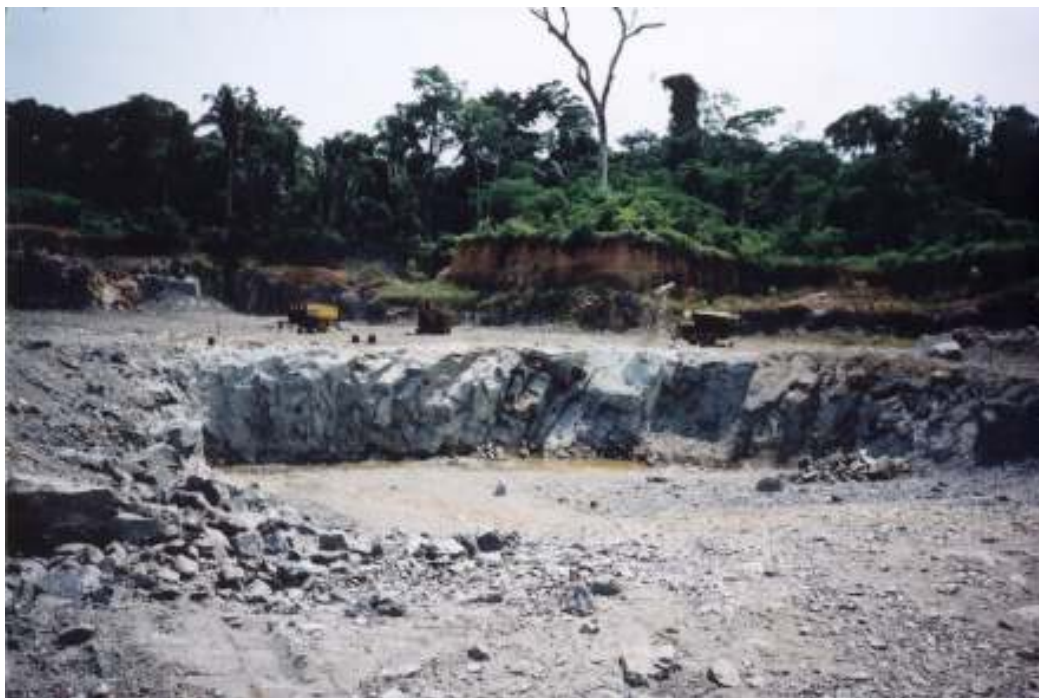
Foto 5 - Frente de lavra em bancada (desmonte para nível inferior). Luiz Antonio-nov/2002
