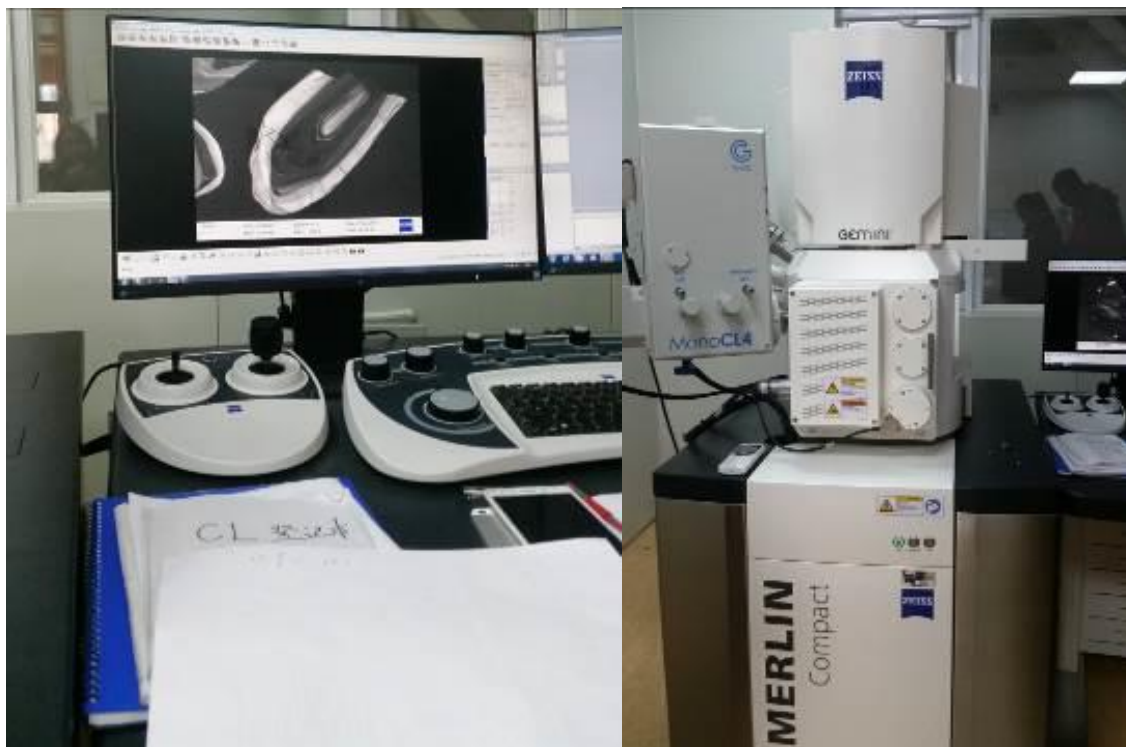
Figura 10. MEV Zeiss produzindo imagens de catodoluminescência.
