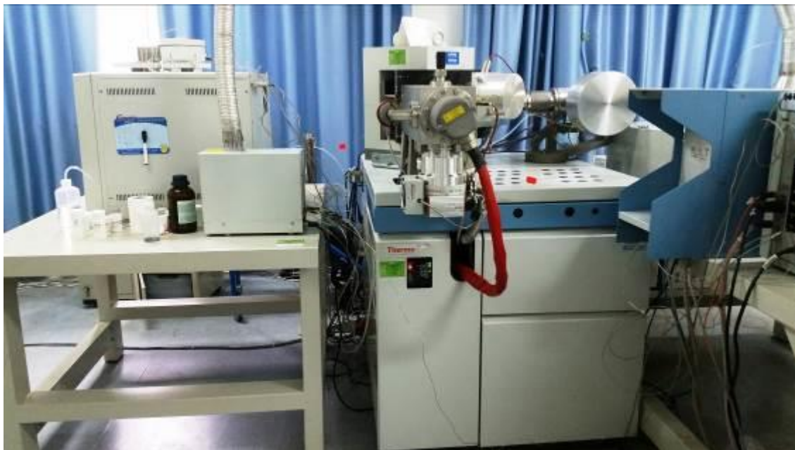
Figura 6. Equipamento para análise de isótopos estáveis THERMO MAT 253.
