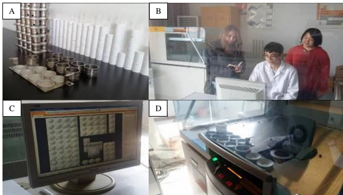
Figura 2. Fluorescência de Raios-X Panalytical X Axios. Em A as amostras; B e C mostram a operação da máquina e D o equipamento.
