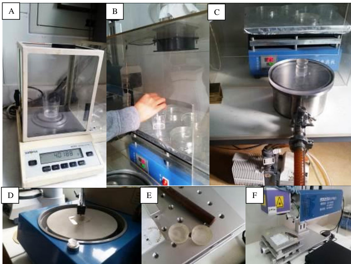
Figura 9. Etapas de preparação de amostras. A) Quantificação de resina; B) Aquecimento da resina com endurecedor; C) Agitação para eliminar bolhas; D) Polimento do mount, E) Gravação a laser da identificação da amostra e F) Laser para gravação de rótulo de mount.
