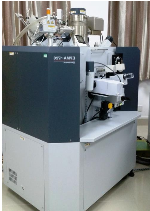
Figura 5. Microsonda eletrônica Shimadzu 1720.
