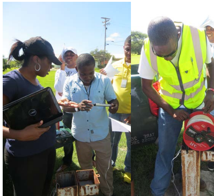
Foto 3. Poço de Monitoramento. a) Extração dos dados armazenados no datalogger; b) Perfilagem de condutividade elétrica e temperatura.
