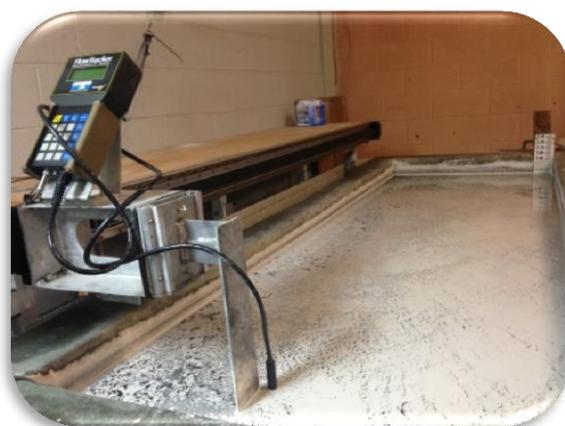
Figura 8: Entrada do “John C. Stennis Space Center”, onde está localizado o HIF (foto à esquerda). Tanque de calibração durante teste em um flowtracker (foto à direita).
