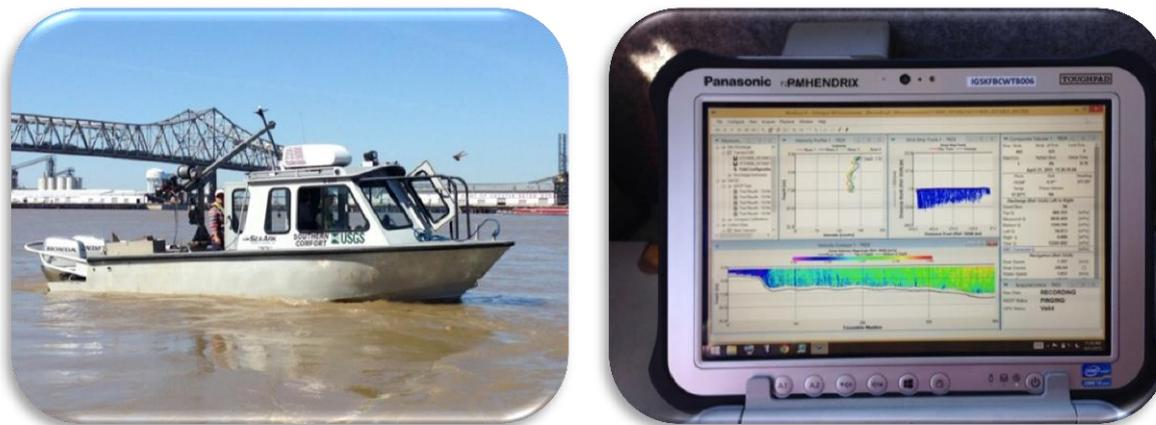
Figura 9: Medição de vazão e coleta de amostra de água na estação Baton Rouge. À esquerda, embarcação de apoio que realizou a coleta de água. À direita, software do ADCP durante a realização da medição de vazão.
