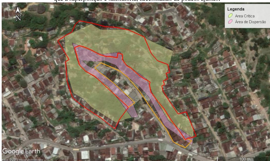
Figura 43 – Setorização do grau de perigo superposto com a área crítica no setor Rua Bom Jesus. Notar que a superposição é satisfatória, necessitando de poucos ajustes.
