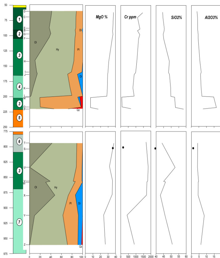
Figura 2.3 – Perfil do furo com minerais normativos. 1: rocha com textura cumulática; 2: textura cumulática mais acentuada; 3: rocha homogênea, afanítica, porfírica; 4: afanítica fraturada; 5: Grupo Jacobina; 6: semelhante a rocha 3, hidrotermalizada; D, C, E,...: amostras; Ol: olivina; Hy: Hiperstênio; Pl: plagioclásio; Di: diopsídio; Qz: quartzo. Profundidade em metros.
