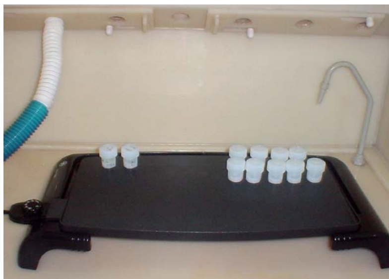
Figura 14 - Chapa quente com savilex.
