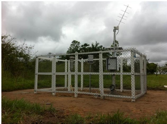
Cercado com um pluviômetro convencional e um automático e uma PCD com transmissão GOES
