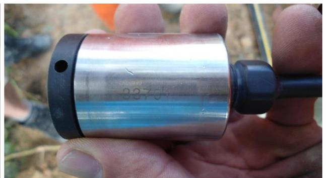
Sensor de nível tipo transdutor de pressão.
