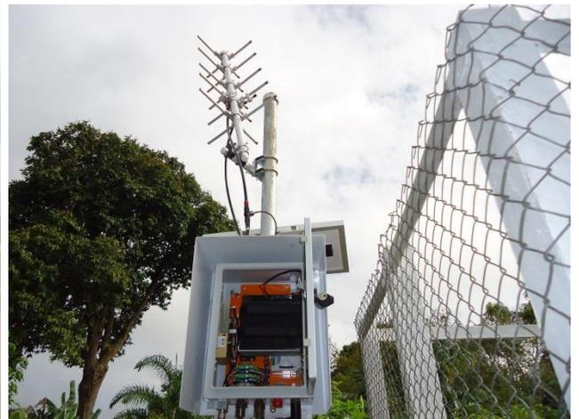
PCD com *datalogger*, painel solar, bateria e antena para transmissão via satélite GOES.
