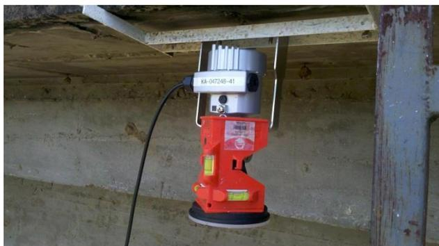
Sensor de nível d'água tipo radar.
