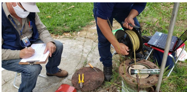
Figura 3: Leitura e extração de dados da RIMAS-BE. Poço Belém-Icoaraci-SAAEB-Souza Franco-FUNASA. SIAGAS: 1500005633. 12/02/2021
