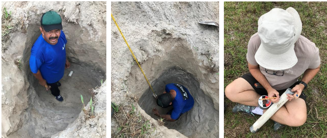
Figura 5: Sequência de procedimentos de coleta da amostra LOE: introdução do tubo na parede da trincheira (foto à esquerda), medição da profundidade (foto do meio) e etiquetagem da amostra (foto a direita).
