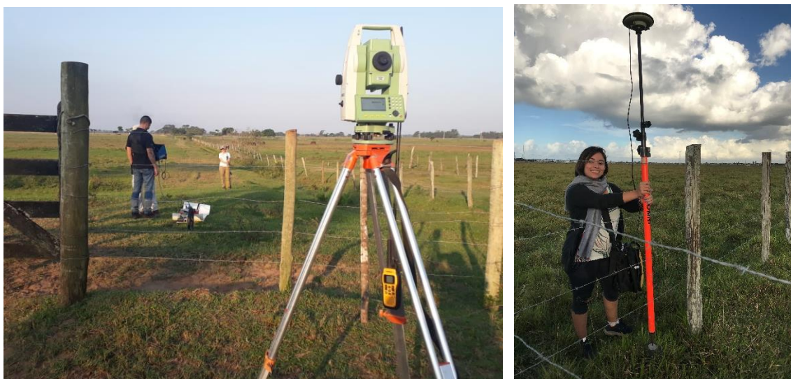
Figura 3: Etapa de campo: topografia, aquisição das linhas de GPR (foto à esquerda) e levantamento altimétrico com GPS geodésico (foto à direita).
