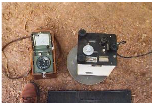
Figura 2 - Altimetro da marca Thommen e gravímetro La Coste & Romberg utilizados nos trabalhos de campo.
