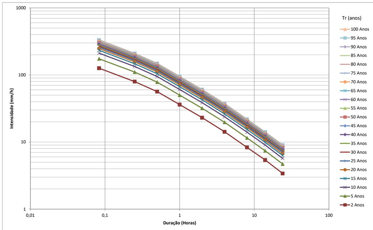
Figura 02 – Curvas intensidade-duração-frequência
