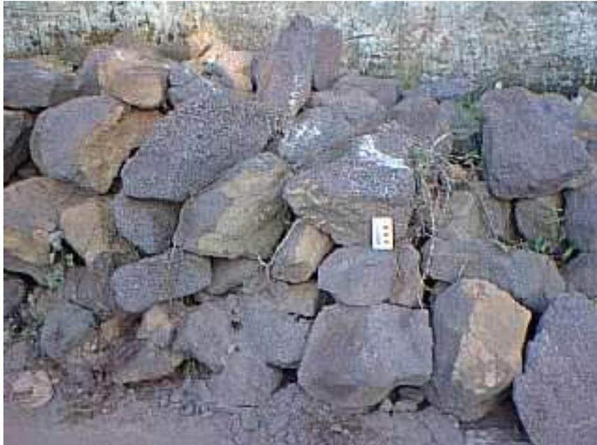
Figure 3.17 – Matériaux utilisés en fondation, Horizon Ferrugineux, faciès Arénite Ferruginisé.
