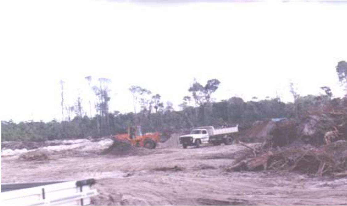
Figure 3.19- Vue générale d'une "arène" en activité dans la l'île de Mosqueiro, avec exploitation de sable (faciès sableux) et "capa de covão" (horizon superficiel du sol).
