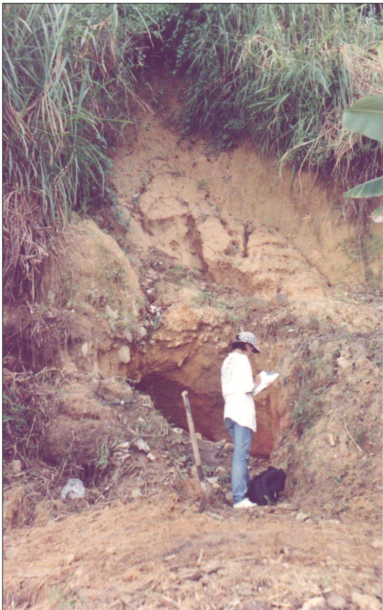
Figure 3.10 – De haut en bas: Horizon de Sol (facies Limono-sableux à Argilo-sablonneux) separé de l'Horizon Ferrugineux (facies Sablonneux Ferruginisé) par couche de Gravier. Il y a sur la couche de gravier une rupture de l'Horizon de Sol.
