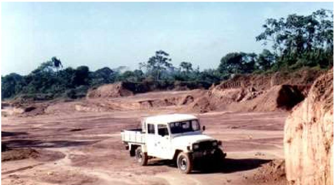
Figure 3.16 - Vue générale du gisement de remblai (faciès Concrétionnaire) e “barro” (Faciès Limono-sableux à argilo sablonneux), en activité dans l’Ile d’Outeiro.
