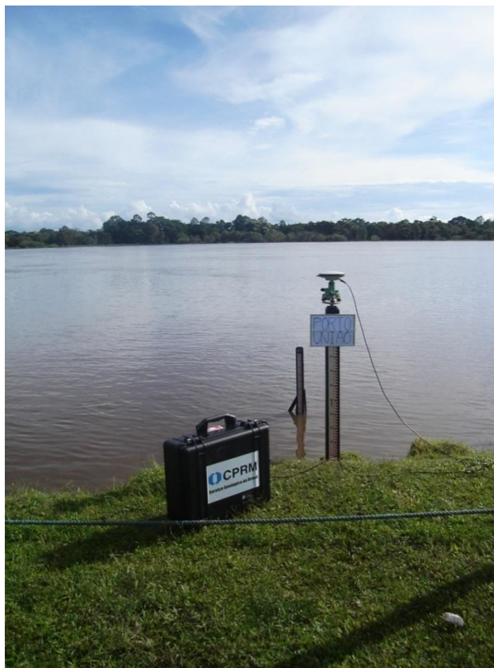
Figura 4 - Ocupação de um lance de régua por receptor GPS para nivelamento da estação fluviométrica de Porto União.
