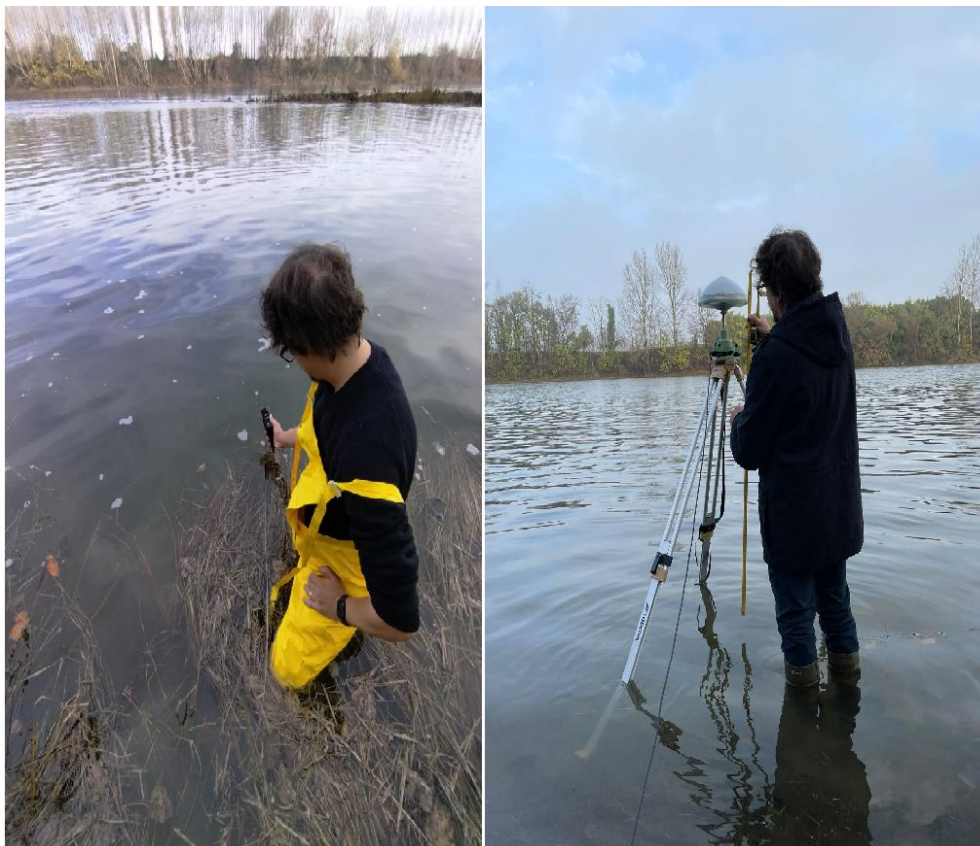
Figura 14 – Coleta de dados de nível de água e nivelamento por GNSS no rio Garona realizada pelo Analista Daniel Moreira.
