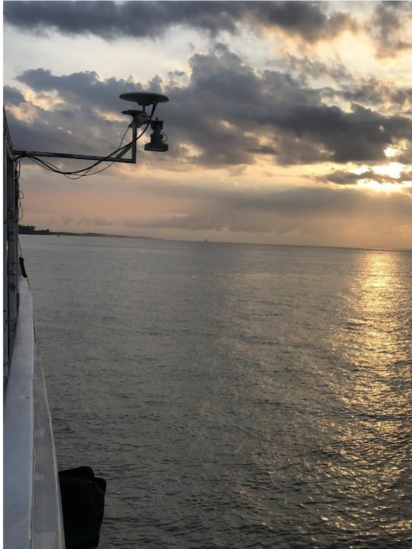
Figura 18 – Exemplo de instalação de receptor GNSS abordo de embarcação fluvial.
