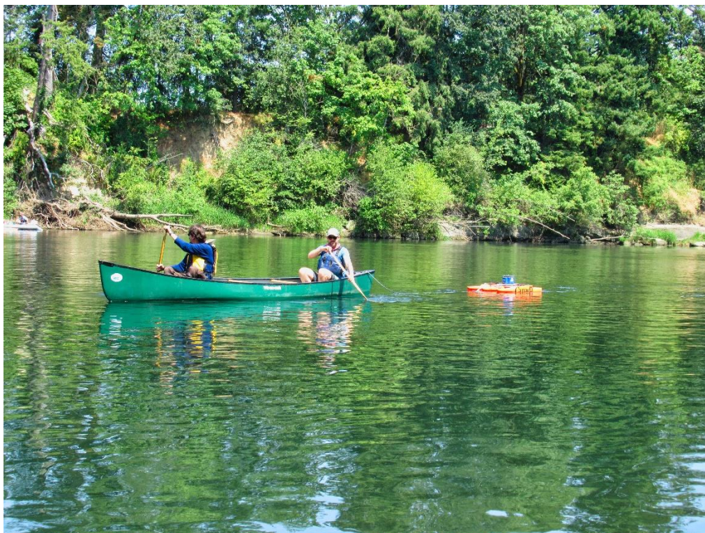
Figura 13 – Medição de ADCP no rio Willamette realizada pelo Analista Daniel Moreira.
