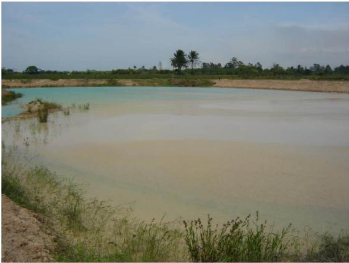
Figura 49 – Exemplo de cava de rejeito de material fino. Nota-se a saturação em material pela turbidez da água.
