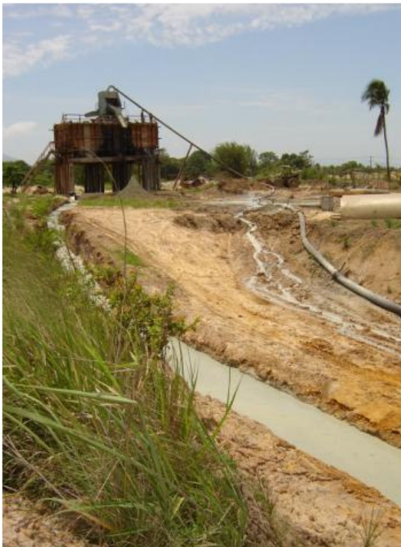
Figura 47 – Processo de separação e descarte de materiais finos pela caixa silo. Repare no canal que é formado pelo fluxo de rejeito (água + finos).
