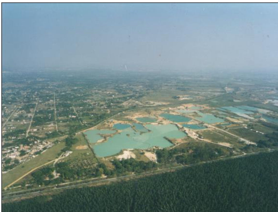
Figura 3 – Vista geral dos areais. O processo de mineração de areia faz com que o lençol freático aflore dentro das cavas.
