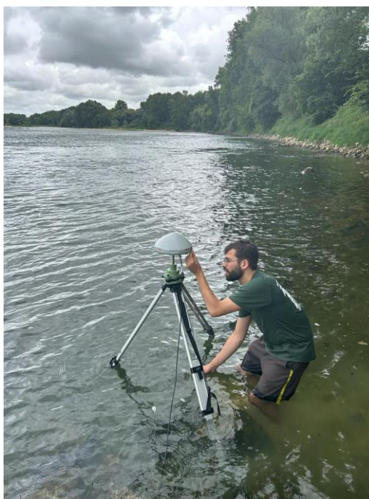
Figura 16 – Coleta de dados de nível de água e nivelamento por GNSS no rio Garona.
