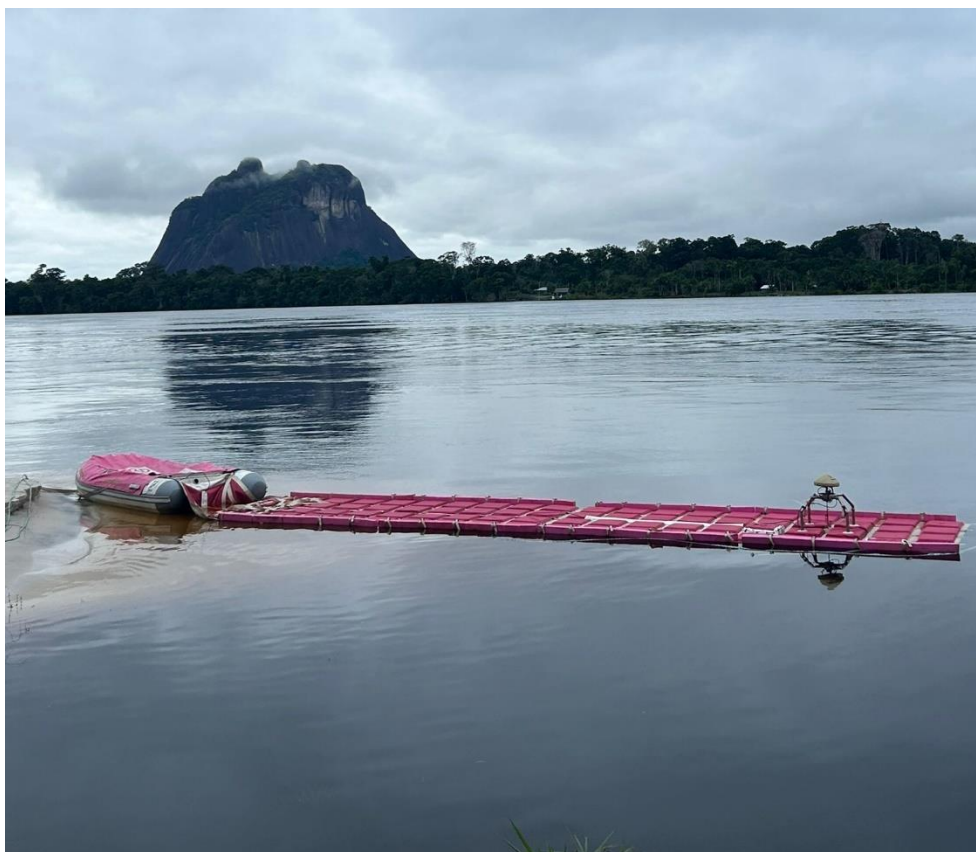
Figura 13 – Coleta de dados da linha de água do rio Negro através de receptores GNSS embarcados na plataforma CALNAGEO.
