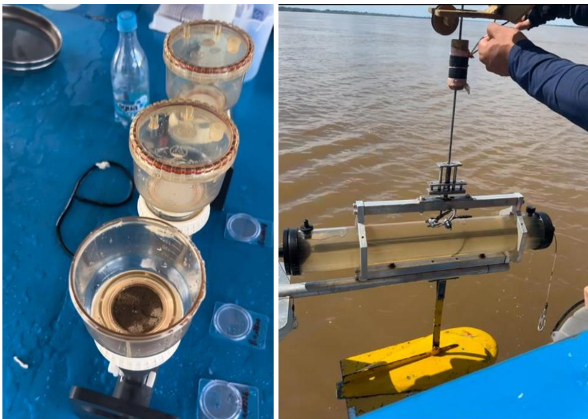
Figura 17 – Amostra de sedimentos na rampa de filtração montada na embarcação e dentro do amostrador de sedimentos pontual do tipo garrafa Van Dorn horizontal antes de ser retirada.
