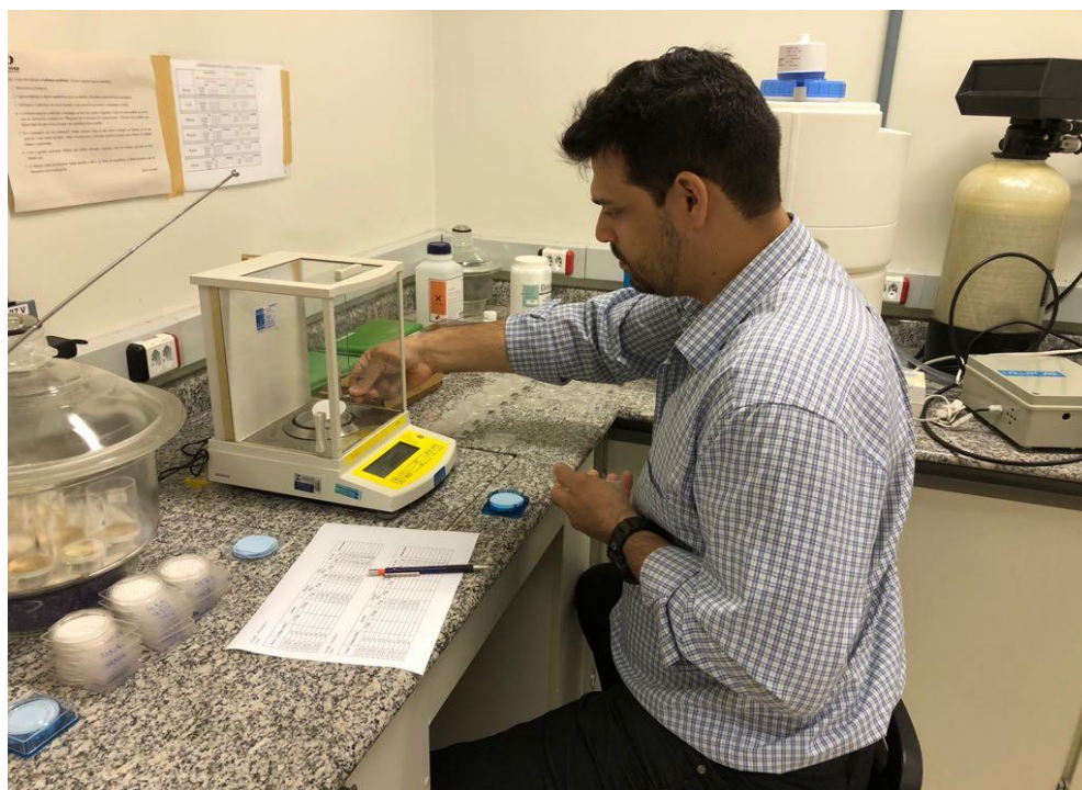
Figura 3 - Pesquisador em Geociências André Santos realizando pesagem dos filtros em balança de precisão, ação fruto da parceria com o LAMIN Manaus.
