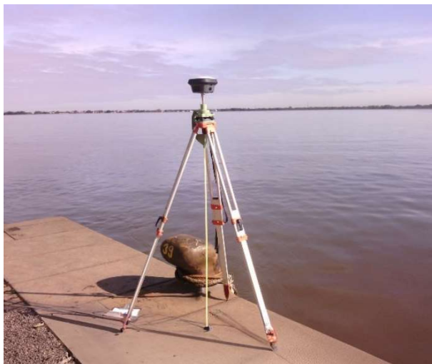
Figura 16: Levantamento com GPS no RN de apoio na cobertura do portão principal da SPH-RS.
