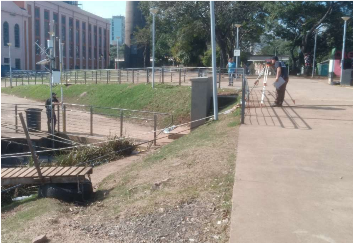
Figura 15: Nivelamento geométrico junto da estação Usina do Gasômetro.
