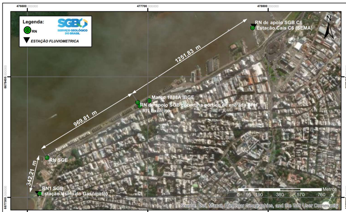
Figura 11: Croqui de localização das estações e pontos de referência ao longo do Cais, entre a Usina do Gasômetro e o Armazém C6.
