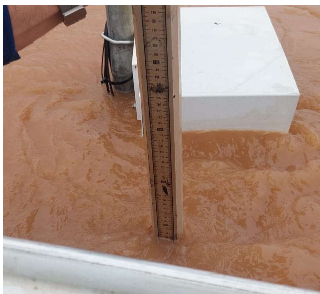
Figura 3: Leitura da profundidade (158 cm) na Estação Cais Mauá C6 (código 87450004) no dia 03/05/2024.
