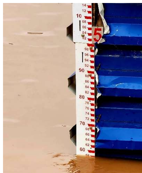
Figura 4: Régua emergencial de apoio (458 cm) na Usina do Gasômetro no dia 03/05/2024.
