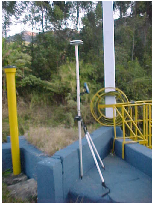
Figura III-13 DGPS base fixa na estação Captação-Copasa
