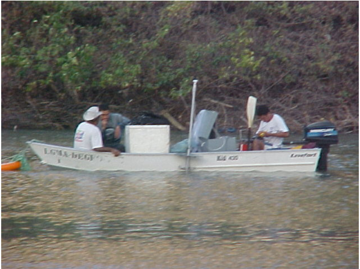
FIGURA 15 - Estação correntométrica e de coleta de água para uma seção no Estuário do Rio choró.
