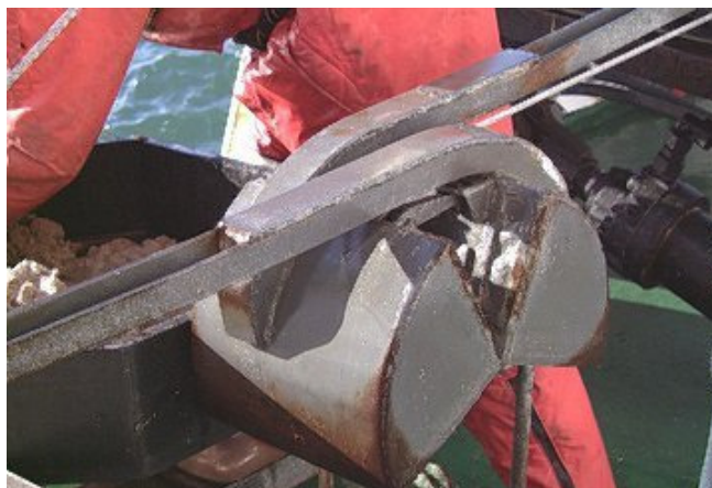
FIGURA 17 - Amostrador ou Busca Fundo do tipo “Van Veen”.
