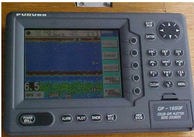
FIGURA 14a - Sonda Ecobatimétrica utilizada na execução da batimetria do Estuário do Rio Choro.
