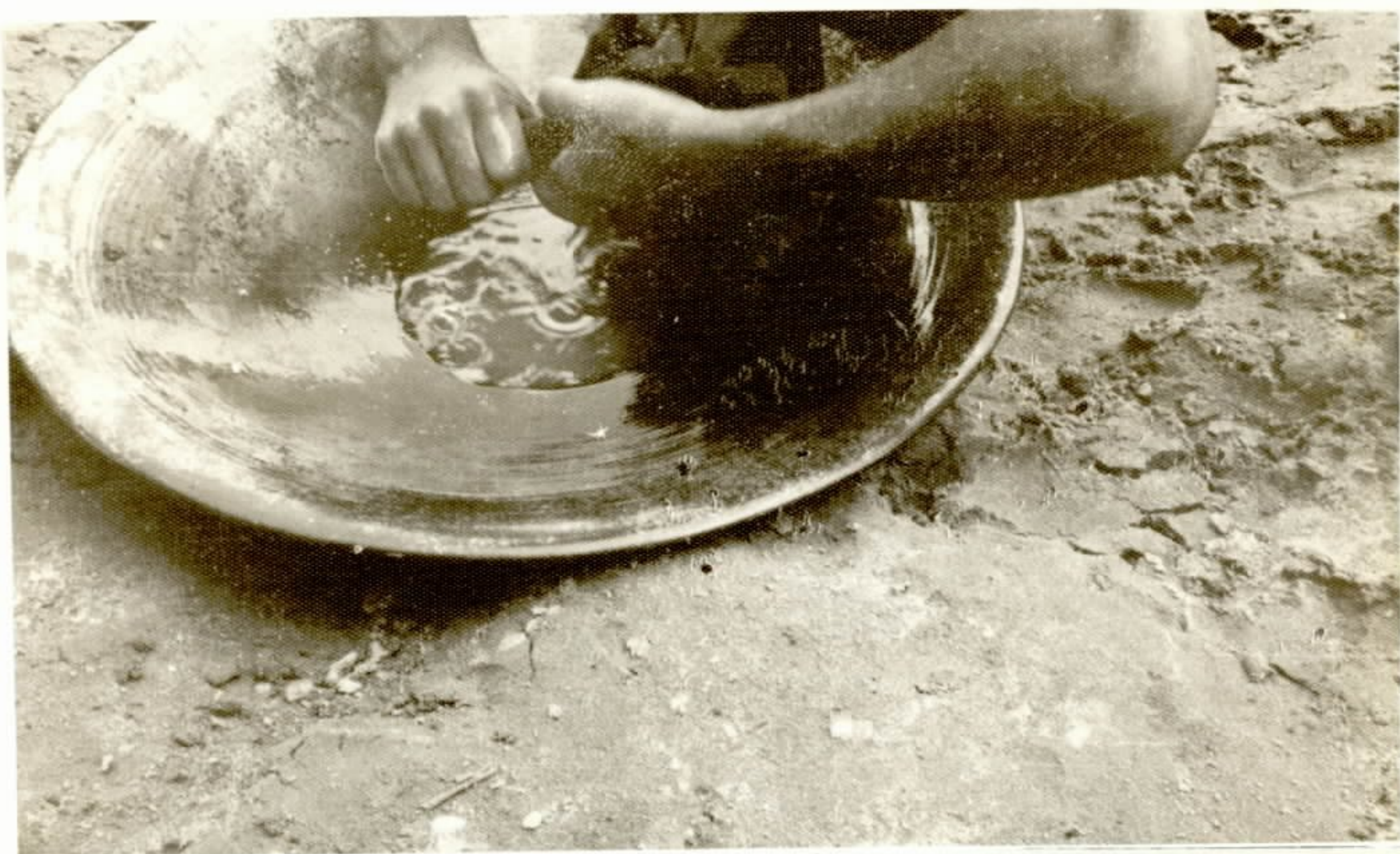
Fotos nºs 9 e 10 - As fotos mostram uma sequência da retirada do excesso de mercúrio utilizado na amalgamação do ouro.
