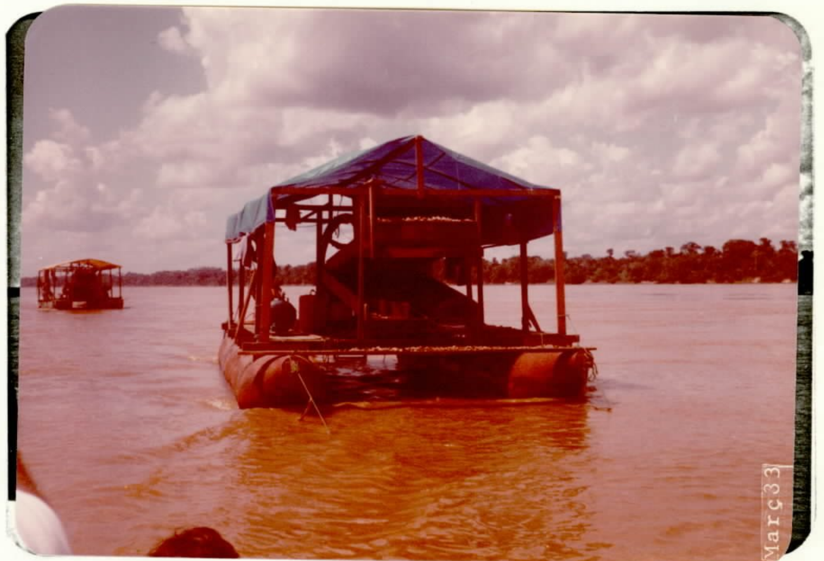
Foto nº 4 - Detalhe de uma balsa, com destaque para a caixa de lavagem ("paraquedas").
