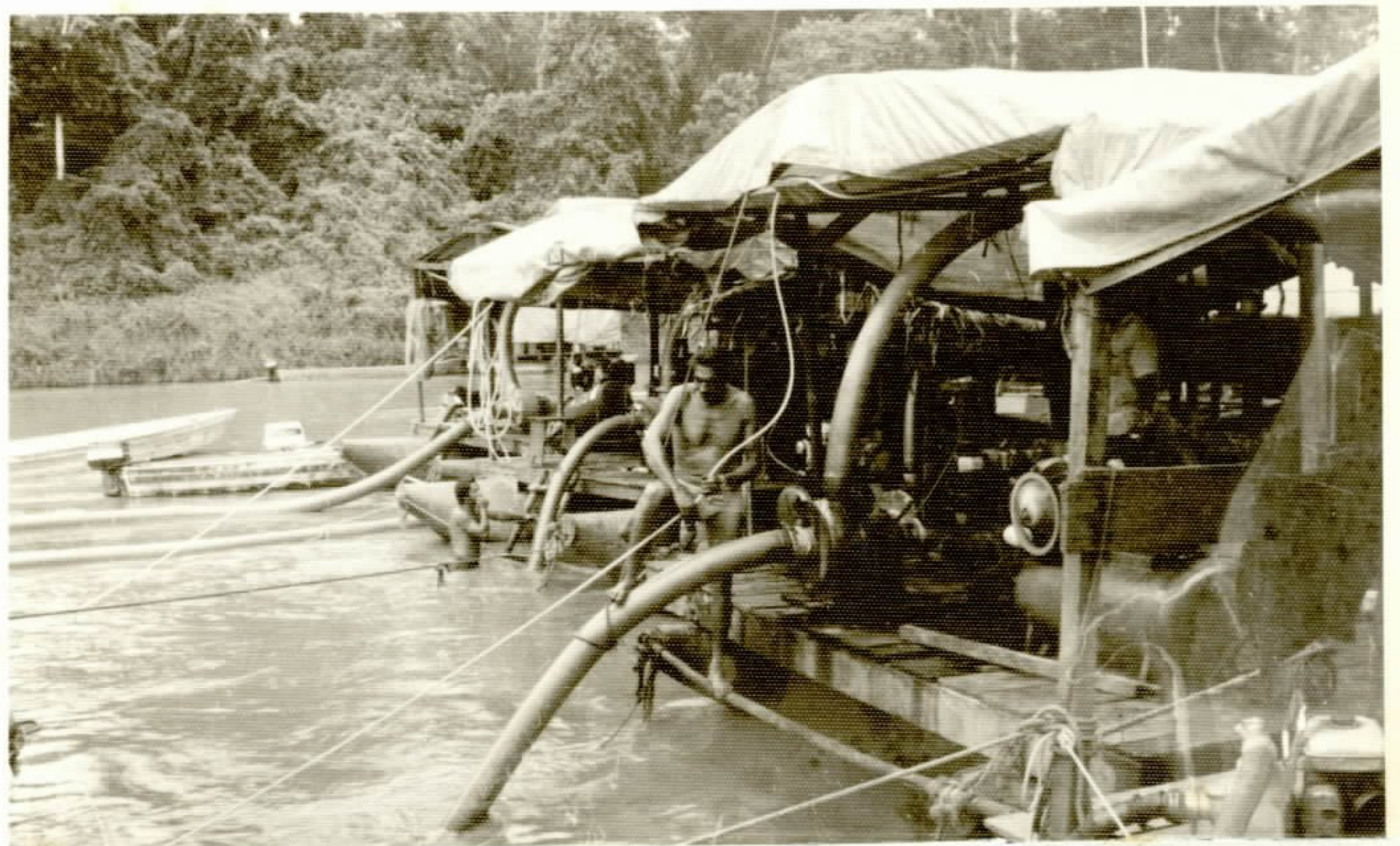
Foto nº 2 - Fila de balsas em operação, onde pode ser observado o homem responsável pelo contato com o mergulhador, através de puxões imprimidos à mangueira de fornecimento de ar.
