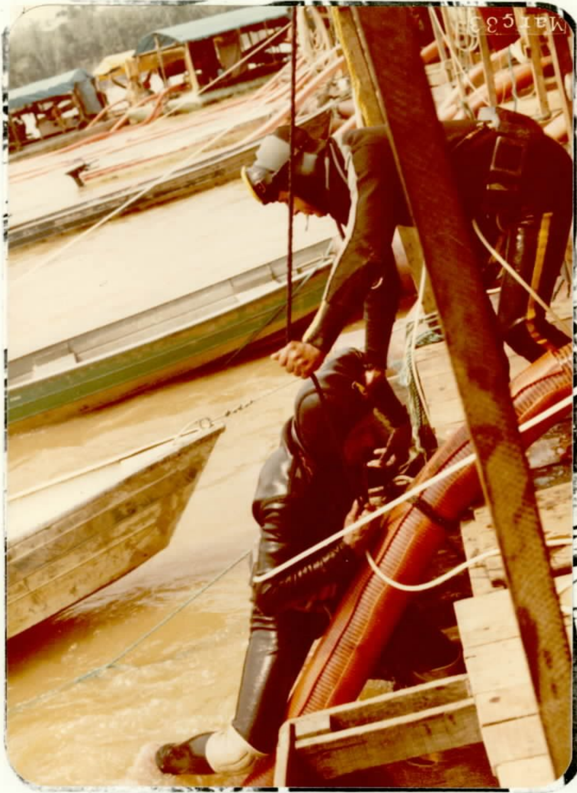
Foto nº 1 - Mergulhador demonstrando nítido sinal de cansaço, após um período de duas horas de trabalho, sendo puxado para a balsa por um companheiro. O cinto preso à cintura é feito com placas de chumbo e pesa de 25 a 30 kg.
