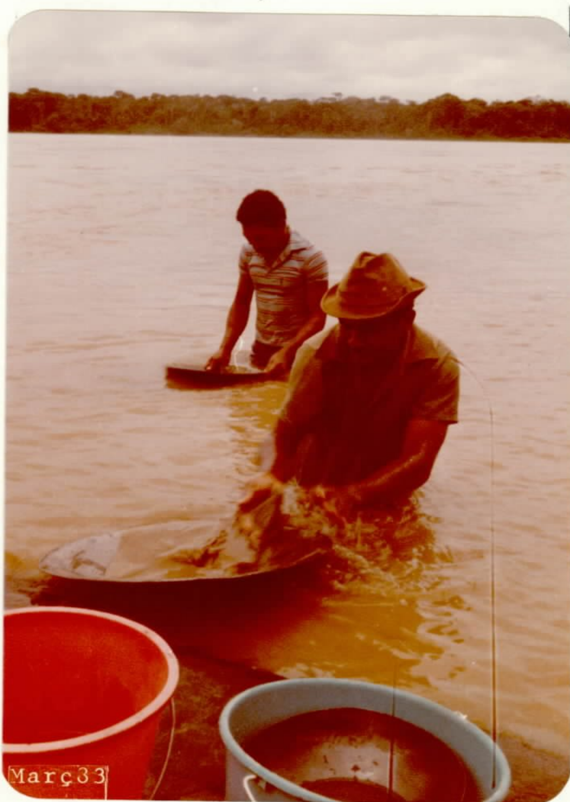
Foto nº 8 - Reconcentração do material aurífero coletado nas balsas ou dragas.
