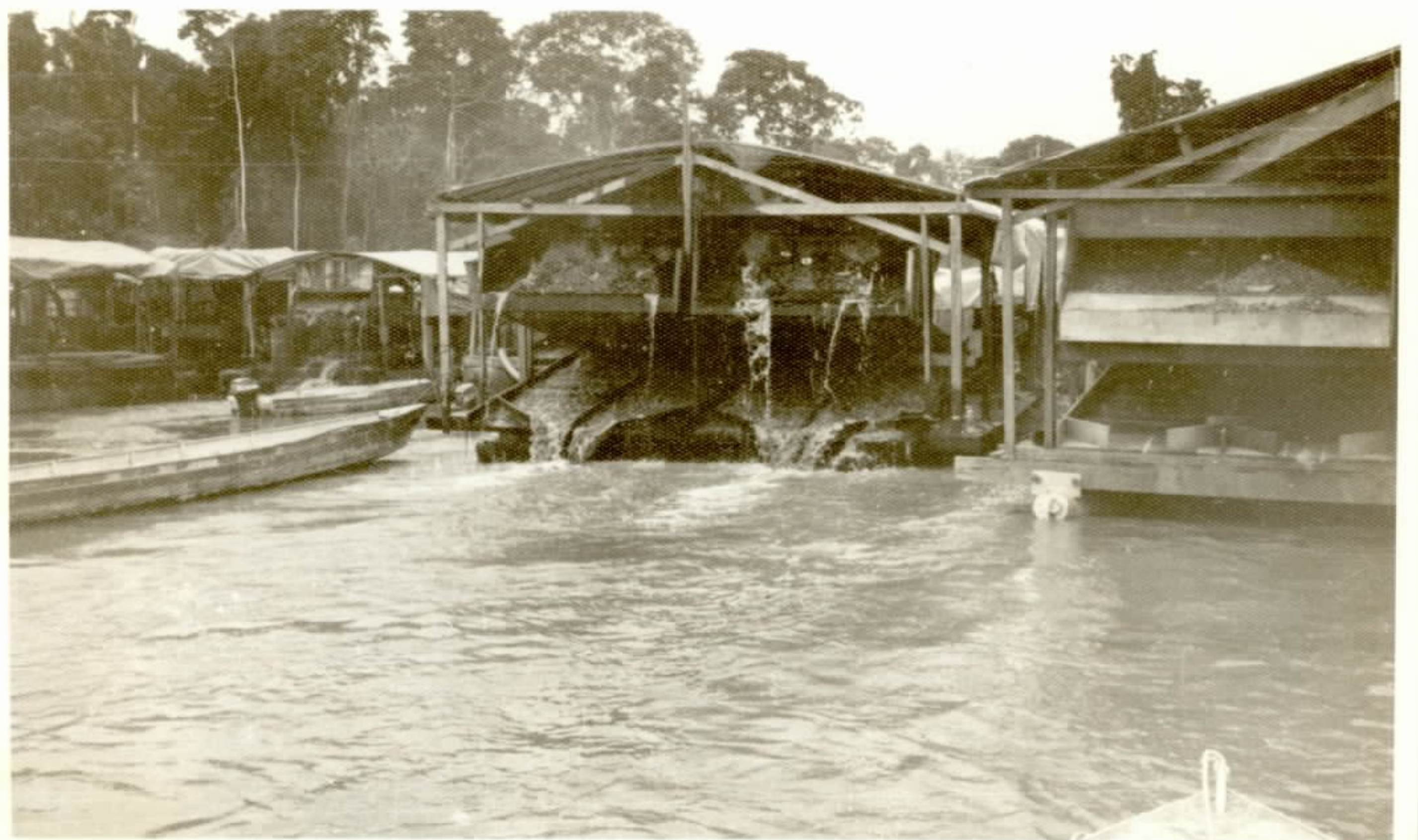
Foto nº 6 - Draga em plena operação de sucção e lavagem do material mineralizado proveniente de depósito do fundo do rio.
