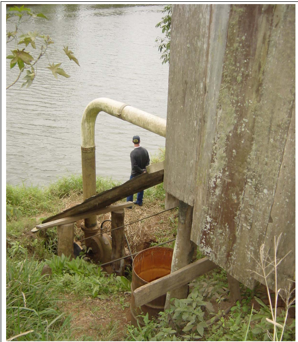
Foto 28: Bomba de sucção de água do rio Itoupava para irrigação de extensa área das planícies de leques aluviais convertidas em canchas de arroz. Local: estrada Araranguá - Ermo, próximo à confluência com o rio Turvo (município de Araranguá).
