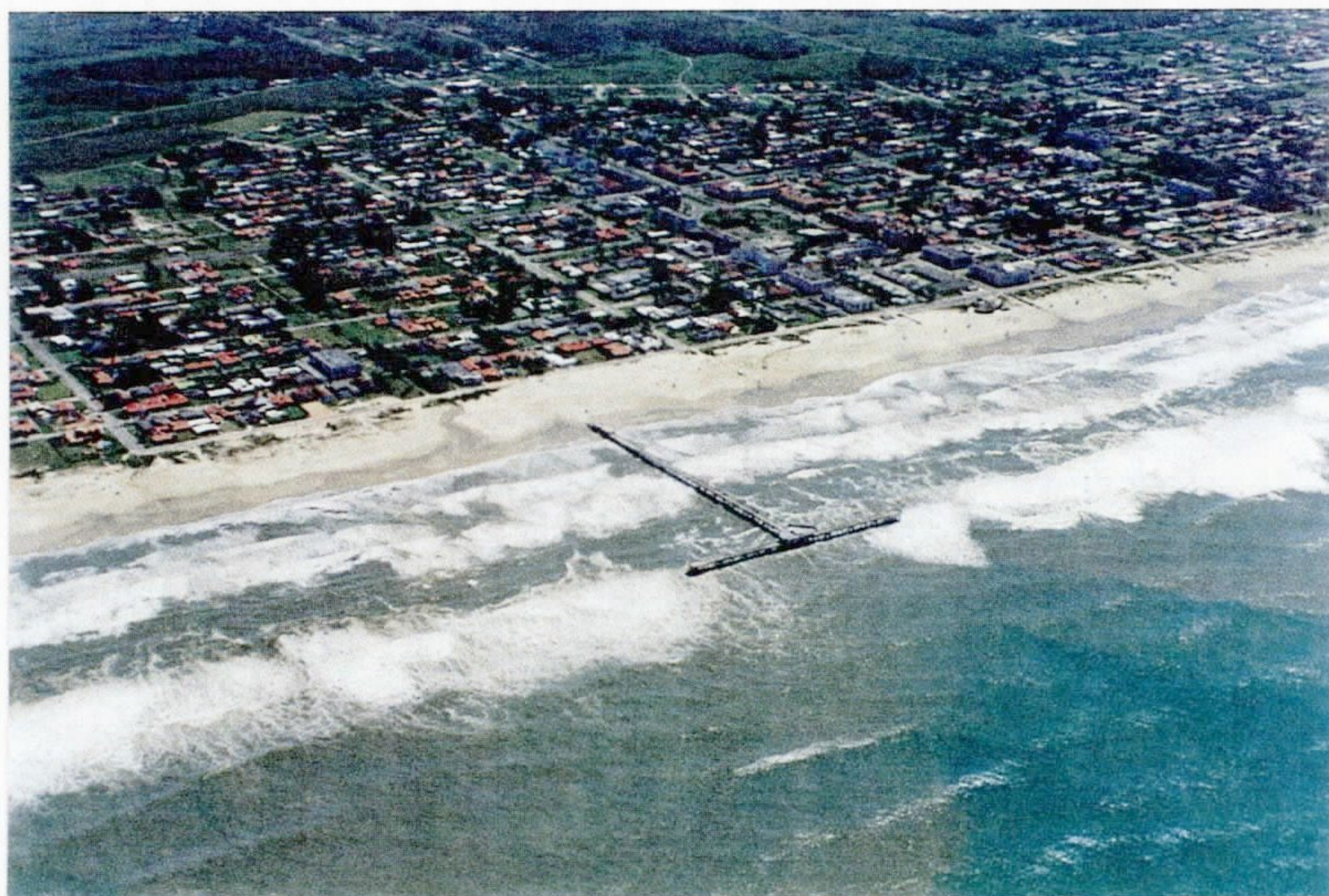
Foto 02 - Vista aérea oblíqua mostrando interferência local no padrão de circulação oceânica, através da fixação de barras arenosas submersas devido aos pilares de sustentação da plataforma de pesca (Balneário de Atlântida).
