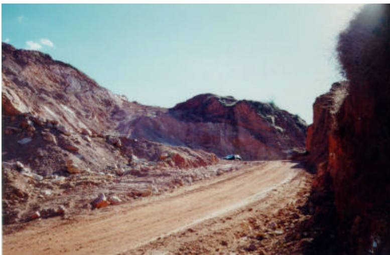
FOTO 4.3 Lavra de quartzito do Grupo Rio Doce Indiviso, utilizado como cascalho e saibro.
