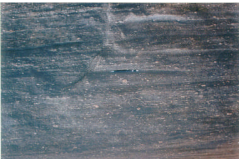
FOTO 2.12 Biotita granito onde os cristais de quartzo/feldspato de dimensões milimétricas a centimétricas encontram-se estirados segundo a foliação. Tonalito Derribadinha.
