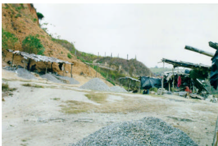
FOTO 4.2 Pedreira com produção manual de brita, no Granito Nanuque. Local: BR-418, 3km a N de Nanuque. Estação: JS-582. UTM: 358700/8030104.
