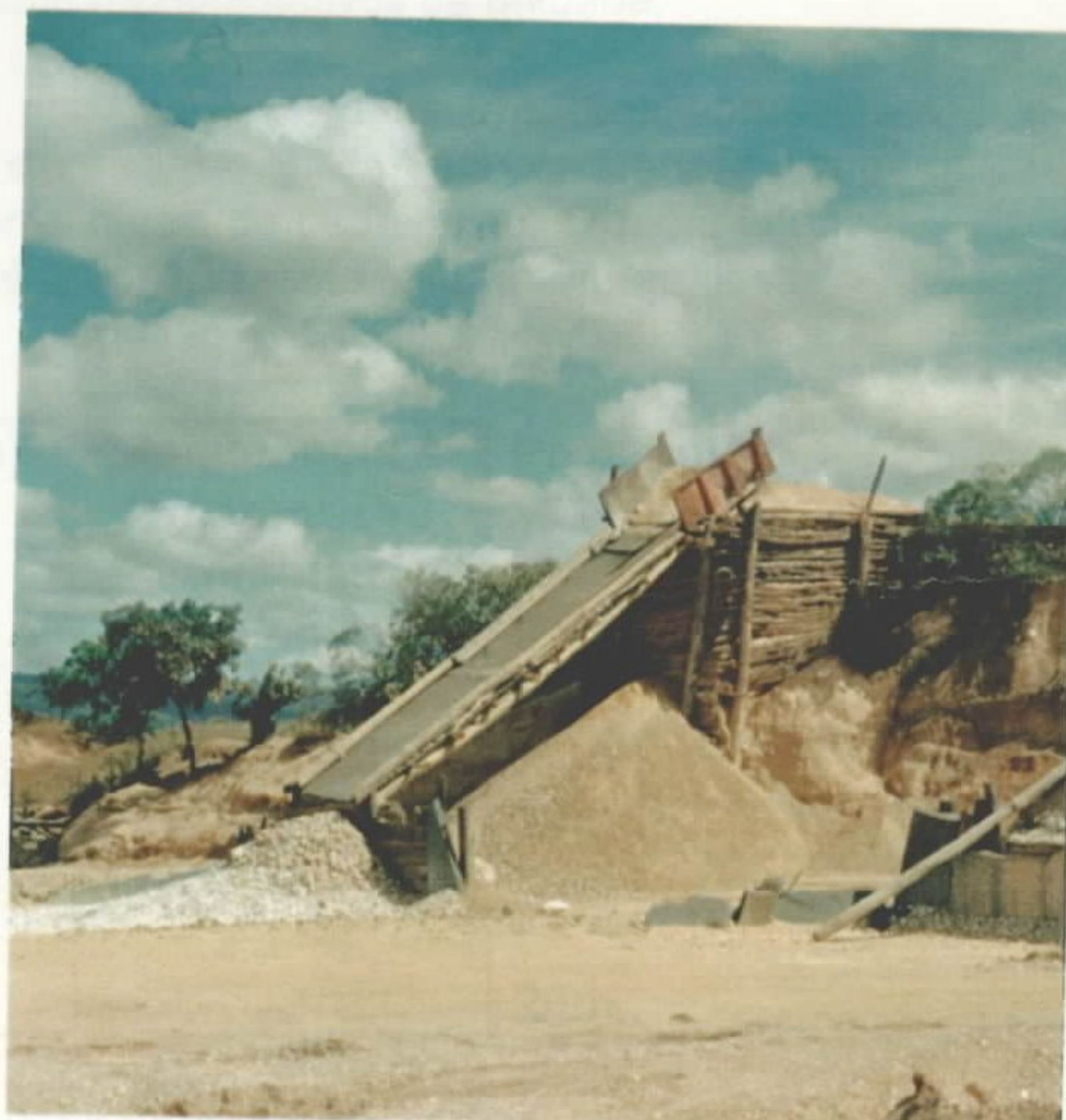
Foto 6: Processo de limpeza e classificação de seixos de quartzo leitoso utilizados como fundente de alto forno. Venceslau Brás, município de Sete Lagoas (MG).
