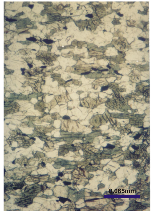
Fig. 9b -Hornblenda (verde) e grunerita (incolor), misturados às porções granoblásticas quartzo-feldspáticas e opacos, configurando uma textura grano-nematoblástica. Aumentada 25 vezes; nicóis//.
