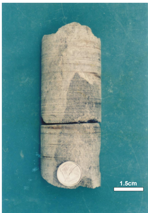
Fig. 19c - Metapiroxenito com xenólito verde-escuro de actinolita-xisto. Furo 02 (120-123m).
