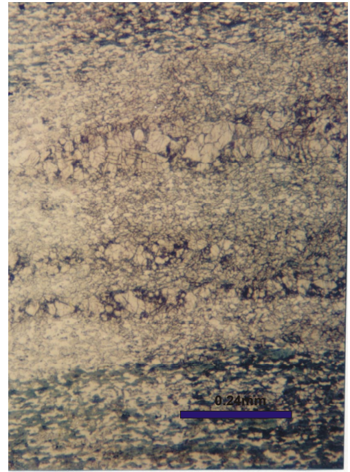
Fig. 18b - Metavulcânica bandada, em que bandas granoblásticas claras de salita, andesina/labradorita e epidoto de 0,25 a 0,62mm são alternadas às bandas verde-escuras nematoblásticas, compostas de hornblenda e andesina/labradorita de 1,5 e 4,5 mm. Aumentada 10 vezes; nicóis//.
