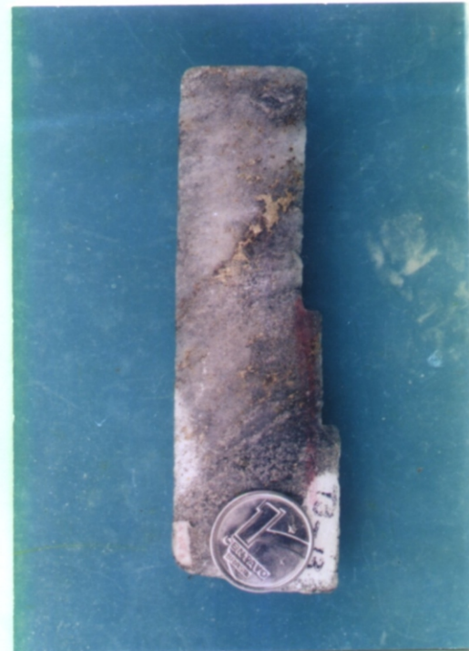
Fig. 33d - Calcopirita esboçando níveis irregulares em rocha xistosa silicificada.
