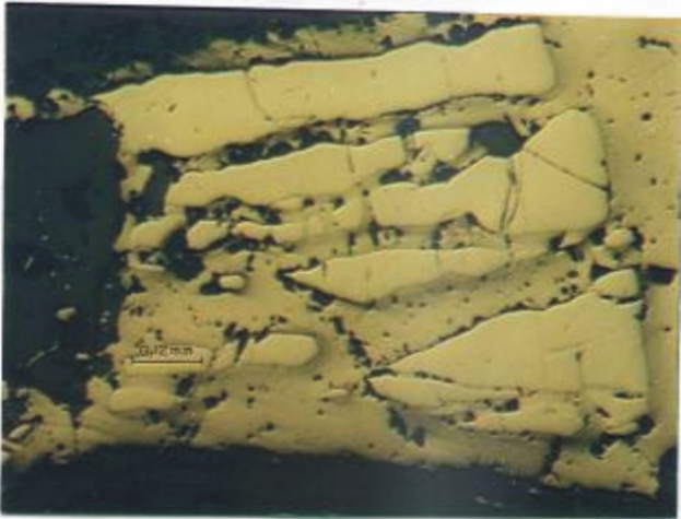
Fig. 35a - Fenoblasto de pirita sendo substituído por pirrotita, formando bandas descontinuas paralelas à foliação. Aumentada 40 vezes; nicóis//.
