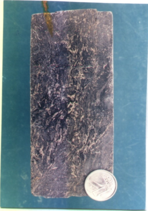
Fig. 33a - Bandamentos delgados e irregulares de sulfetos milonitizados, concordantes com a foliação regional ( 70^{\circ} - 80^{\circ} NE)
