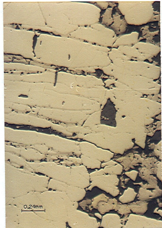
Fig. 34d - Pirrotita e calcopirita preenchendo fraturas tensionais em pirita. Aumentada 40 vezes; nicóis //.
