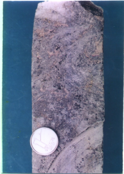
Fig. 33b - Manchas amareladas de sulfetos infiltrados nos planos de xistosidade.
