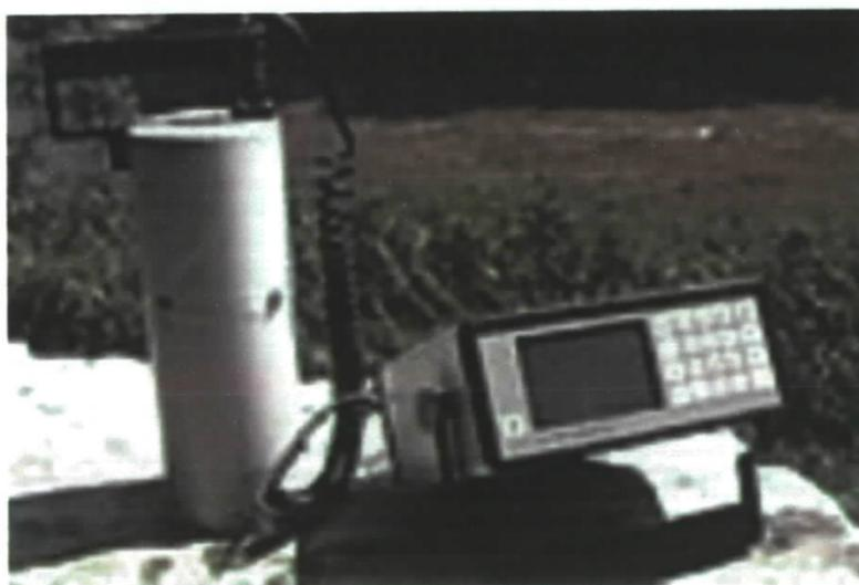
Figura I.1 – Gamaespectrômetro Portátil EXPLORANIUM GR-320
