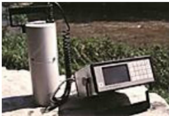
Figura I.1 – Gamaespectrômetro Portátil EXPLORANIUM GR-320
